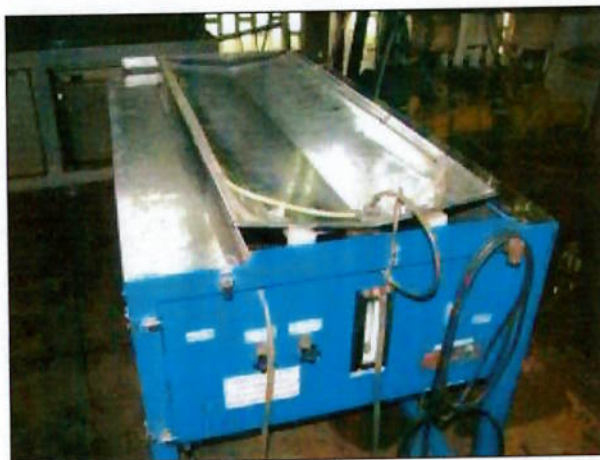
Figura 7 - Mesa Mozley utilizado nos estudos
