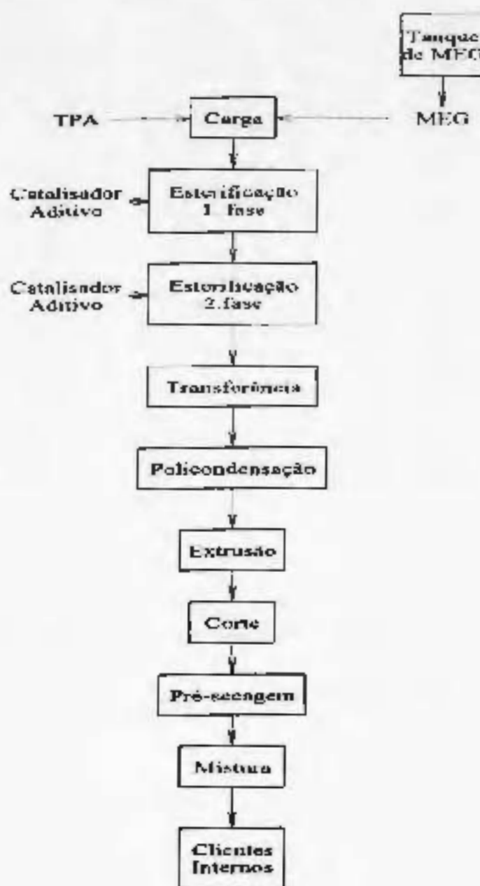
Figura 2.3 - Fluxograma da Fabricação de PET com TPA e MEG
