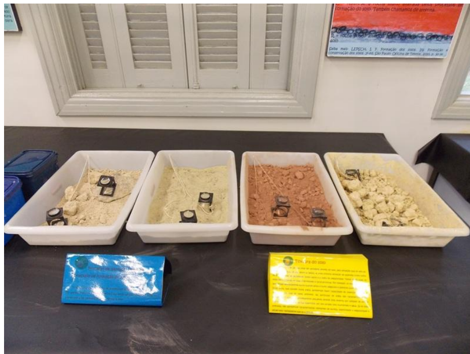
Figura 16 Experiência de textura do solo. Na imagem temos quatro bandejas contendo respectivamente a rocha em decomposição, areia, silte e argila (Fonte: Marina Manganotte, 2015).
