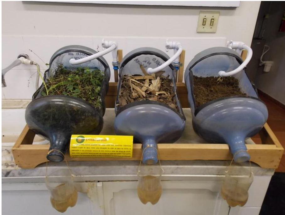
Figura 21 Experimento sobre Erosão do solo (Fonte: Marina Manganotte, 2015).
