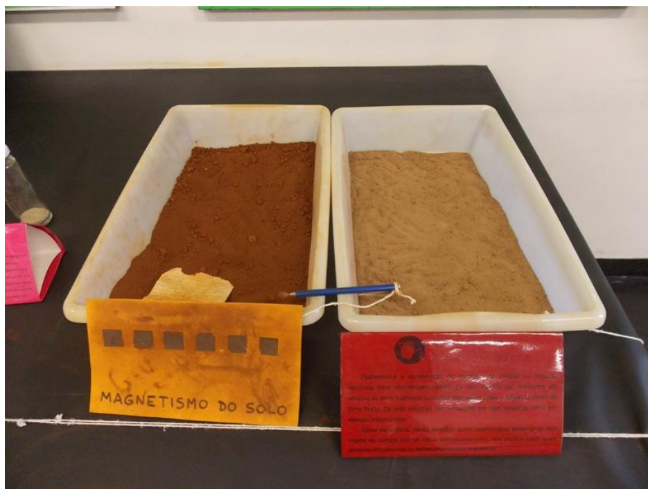
Figura 18 Experimento de magnetismo do solo. Aqui a criança pode utilizar uma caneta imã para perceber a diferença entre uma amostra de solo com muito metal magnético (esquerda) e outra com menos (direita) (Fonte: Marina Manganotte, 2015).
