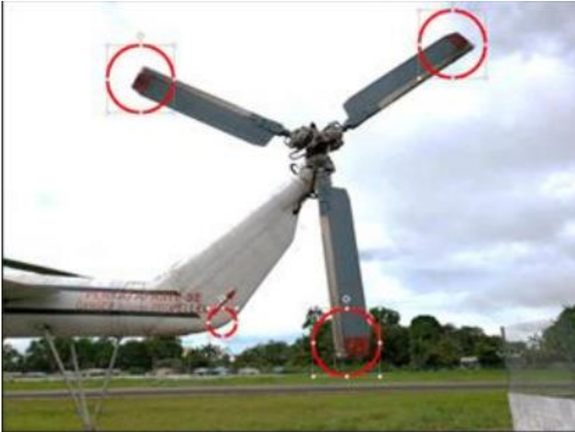
Figura 26 - Vista da seção traseira da aeronave. No detalhe em vermelho, observam-se os danos causados pela colisão. Fonte: http://sistema.cenipa.aer.mil.br/cenipa/paginas/relatorios/rf/pt/PRBRU_01FEV2019_IG..pdf
