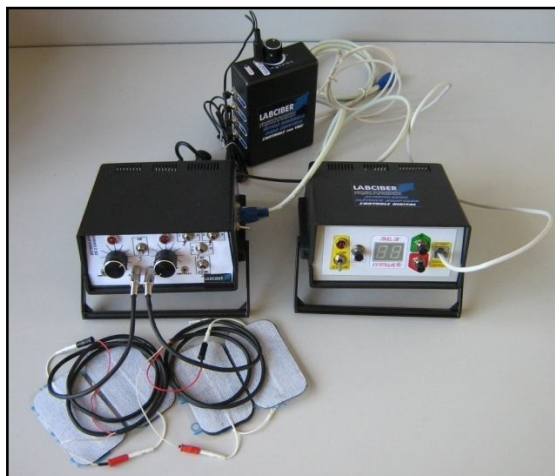
Figura 6-21 – Estimulador Elétrico Adaptado, Módulo de Controle Digital e Módulo de Controle por Comando por Voz
