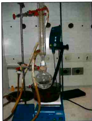
Figura 7: Sistema de refluxo usado nas sínteses C.
