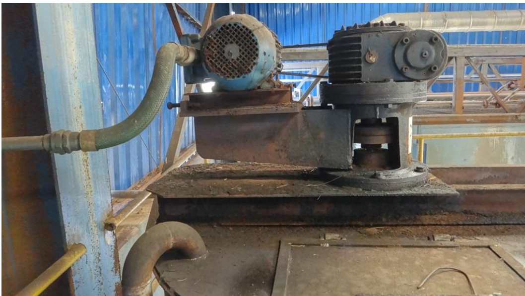
Figura 19 - Acionamento de sistema de agitação por correia e desprotegido.
