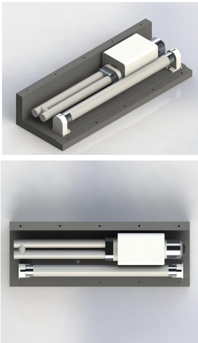
Figura 2-6 Gabinete construído para fixação das lâmpadas
