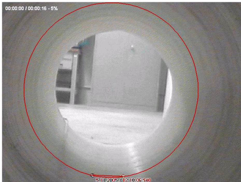
Figura 10 - Tubulação sem deformação.
