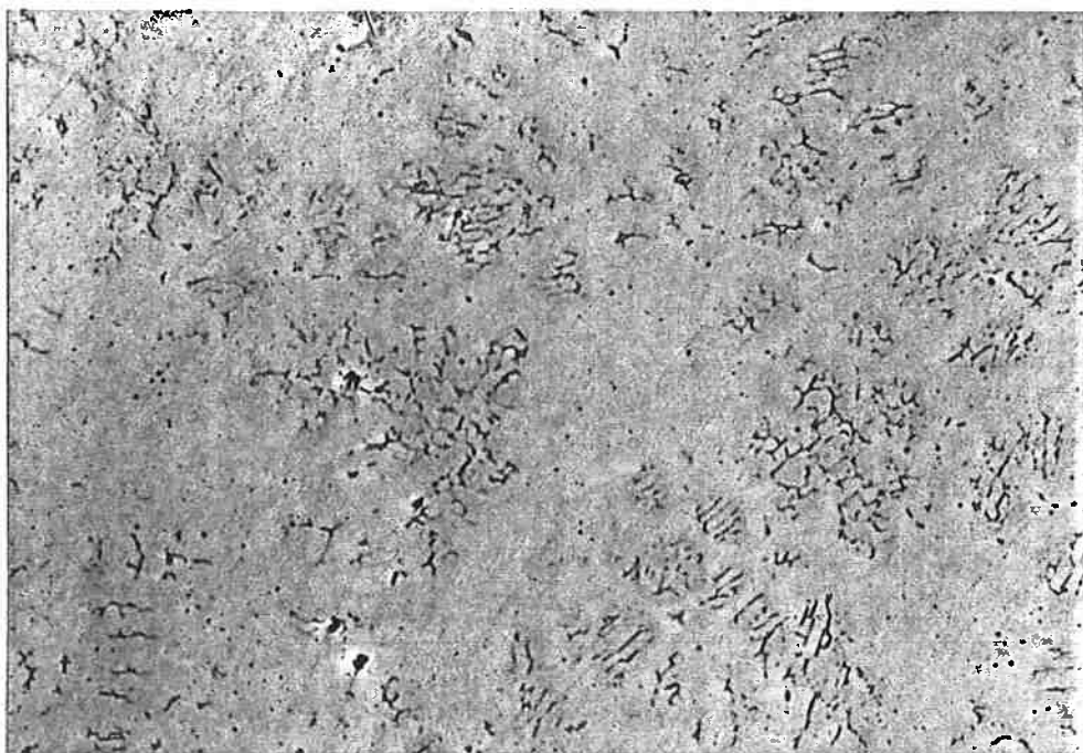
fig.22 - microestrutura da zona equiaxial, Cr_{eq}/Ni_{eq}=1.56 , refusão. 100X, ataque solução KOH.
