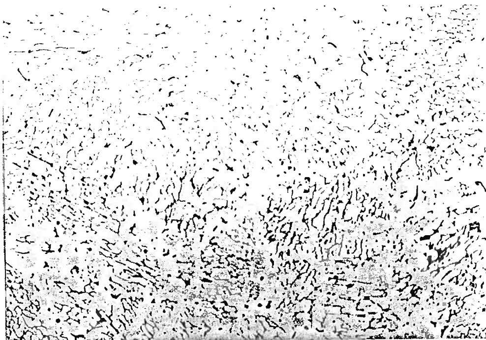
fig.20 - microestrutura da zona equiaxial, Cr_{eq}/Ni_{eq}=1.9 100X, ataque solução KOH.
