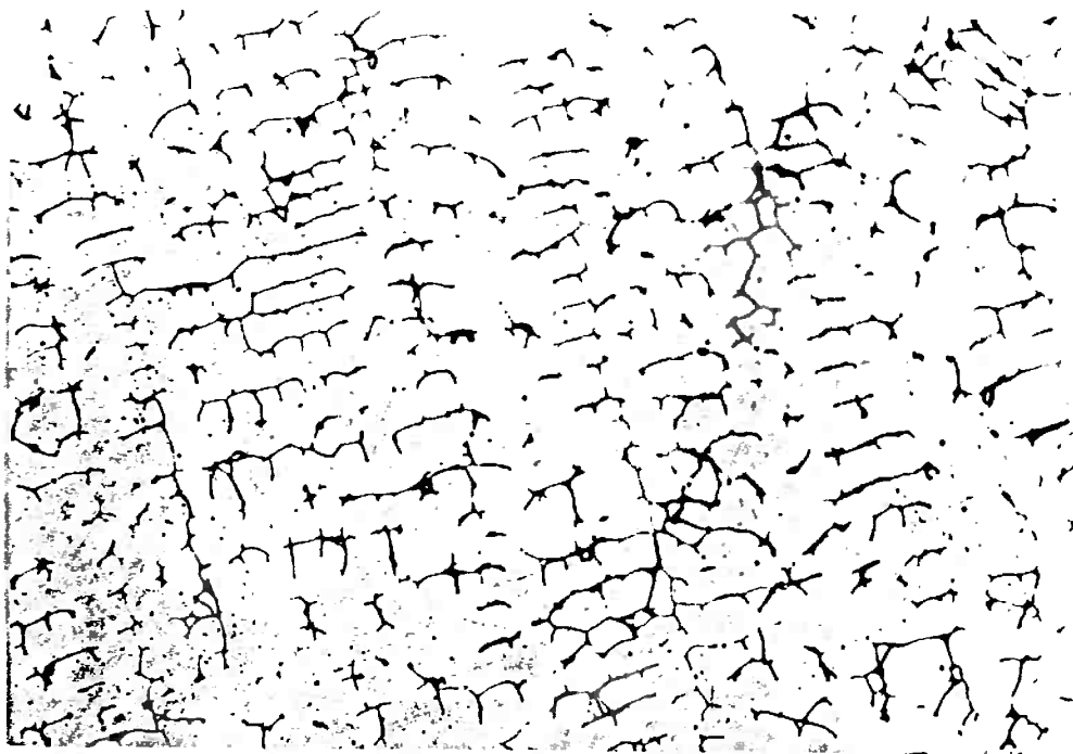
fig.17 - microestrutura da zona colunar, Cr_{eq}/Ni_{eq}=1.56 100X, ataque solução KOH.
