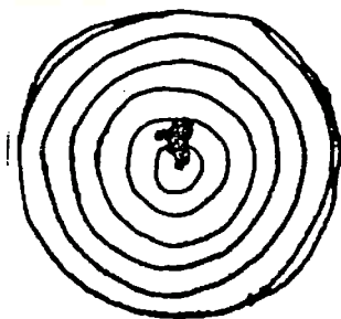
fig.46 - linhas isoteor de \delta , 1º fusão, Cr_{eq}/Ni_{eq}=1.7 .
