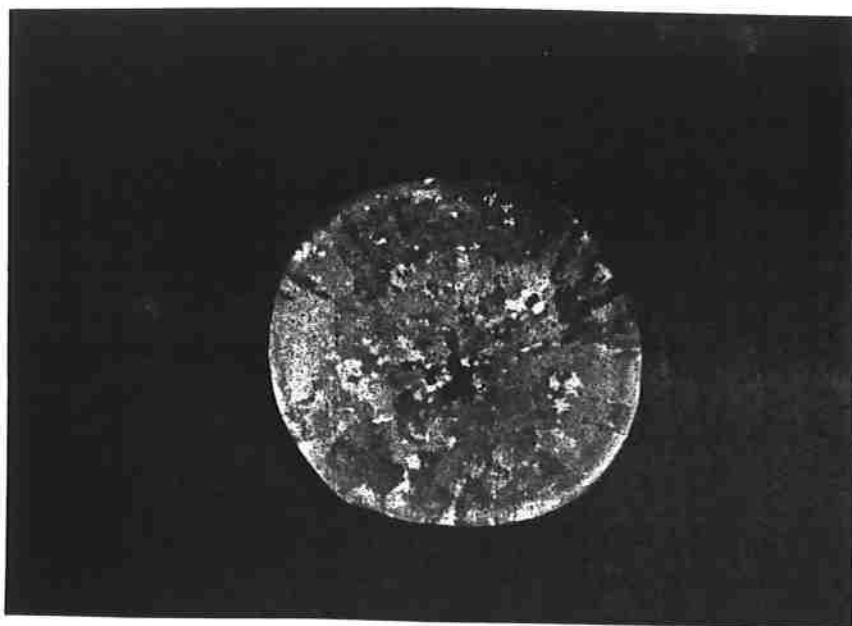
fig.37 - macrografia, 1º fusão, Cr_{eq}/Ni_{eq}=1.7 , modo de solidificação: \delta \rightarrow \gamma . aumento 1.3X, ataque solução Lepitos.
