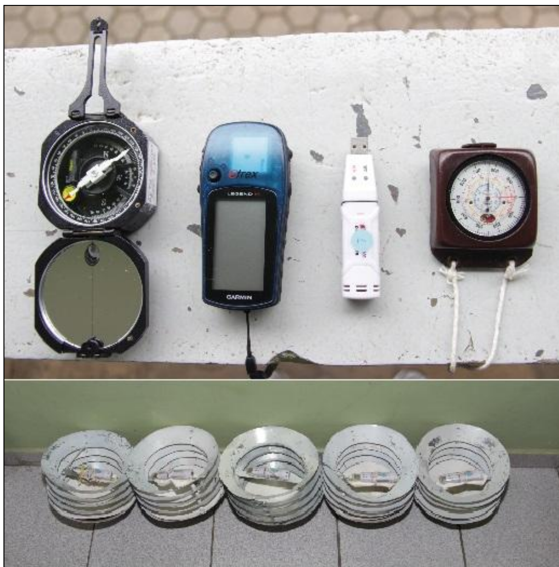
Figura 10 – Equipamentos utilizados para coleta de dados, na foto superior (bússola, GPS, termo-higrômetro (data logger – HT500) e altímetro), na foto inferior (mini-abrigos meteorológicos e data loggers – HT500). Foto: Abiqueila Souza Silva, 2013.
