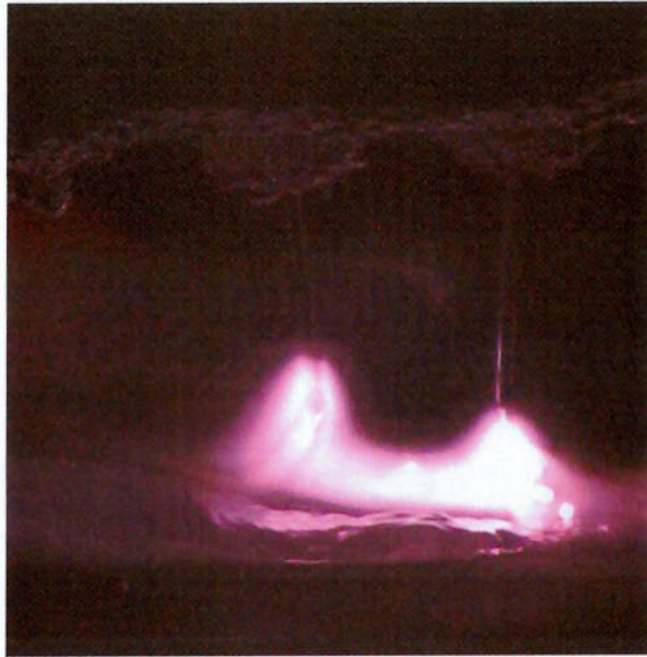
Figura 2.5.2.2 - Foto tirada durante a soldagem com o processo Twin-Arc [6].
