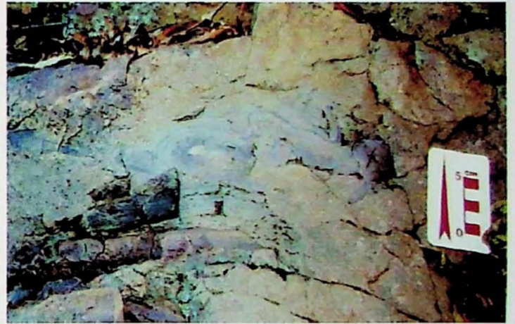
D. Facies Ag. Arenito médio a grosso, com clastos dos siltitos laminados inferiores deformados.
