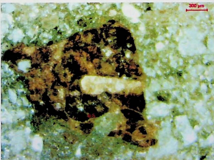
E Amostra KBU- 14A, lapilli -tufo com litoclastos apresentando textura esferulítica (es).
