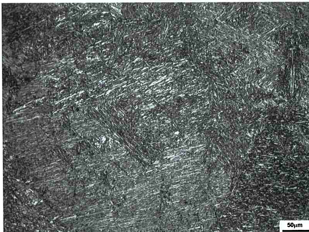
Figura 23 - Imagem da seção transversal da amostra temperada a 308 °C e particionada a 350 °C, durante 10 s, pré atacada com Nital 2% e atacada com Beraha.
