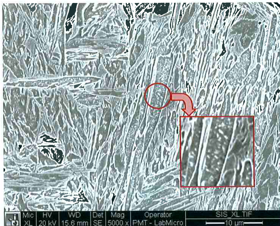
Figura 35 - Imagem feita no MEV da seção longitudinal da amostra temperada à 308 °C, particionada a 350°C, durante 10 s, atacada com Nital 2%. Indicado pelo círculo, observam-se no interior das ripas formas de coloração mais clara, prováveis carbonetos.
