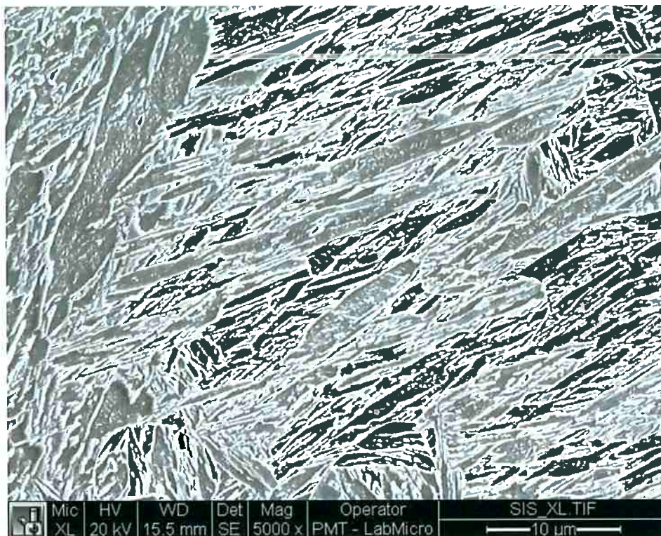
Figura 40 - A imagem foi feita com MEV, de amostra temperada a 308 °C, particionada a 350°C durante 100 s.
