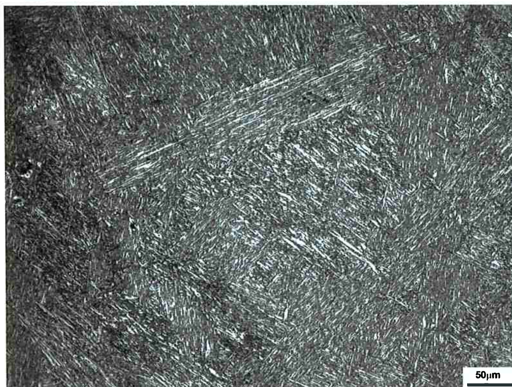
Figura 20 - Imagem da seção transversal da amostra temperada a 288 °C e particionada a 350 °C, durante 10 s, pré-atacada com Nital 2% e atacada com Beraha.
