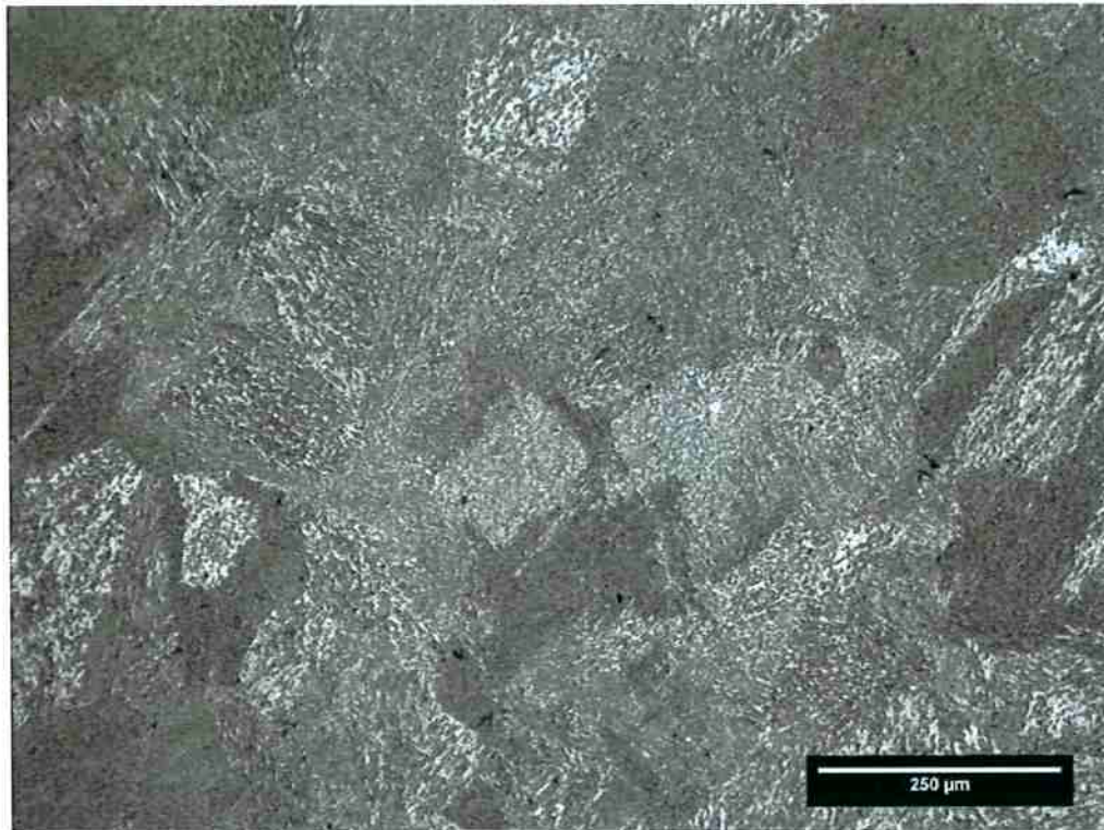
Figura 16 - Microestrutura da amostra homogeneizada, feita em Microscópio Óptico, ataque realizado com Nital 2%.
