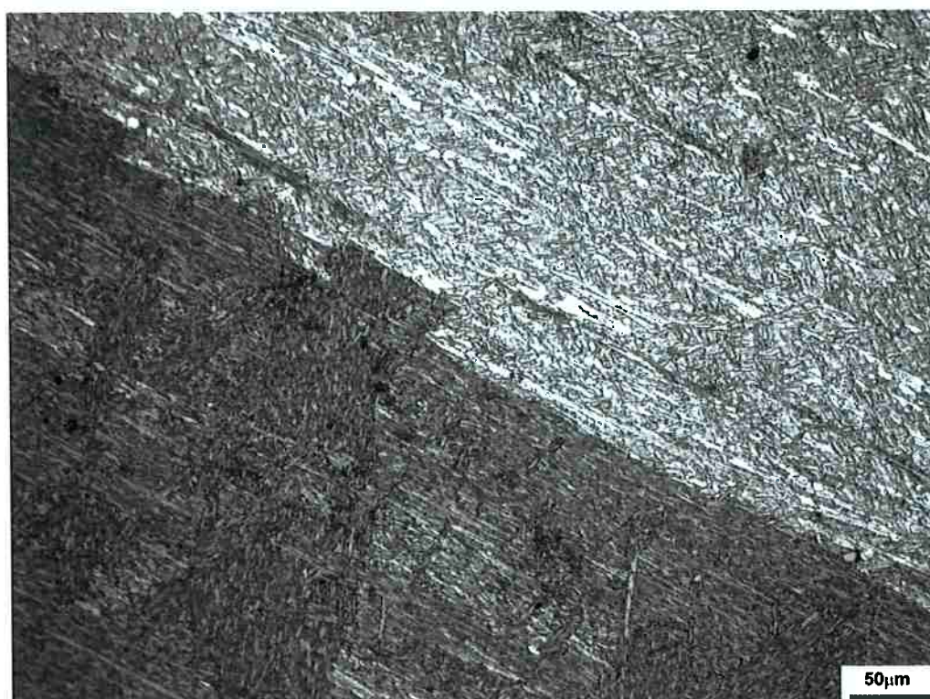
Figura 26 - Imagem da seção transversal da amostra temperada a 328 °C e particionada a 350 °C, durante 10 s, pré atacada com Nital 2% e atacada com Beraha. Detalhe de um antigo contorno de grão austenítico.
