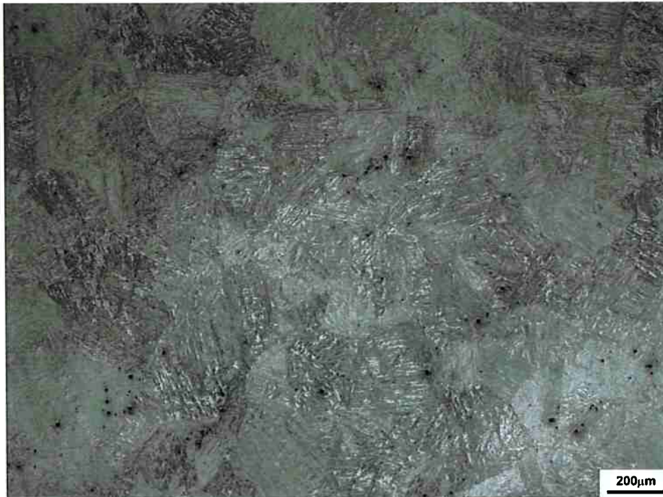
Figura 18 - Imagem feita em microscópio óptico, de amostra temperada, atacada com Nital 2%.
