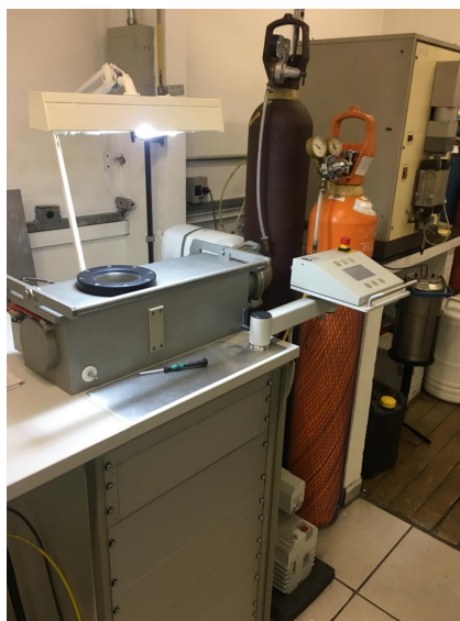
Figura 21: Dilatômetro utilizado para os ensaios
