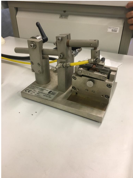
Figura 20: Solda utilizada para fixar o termopar
