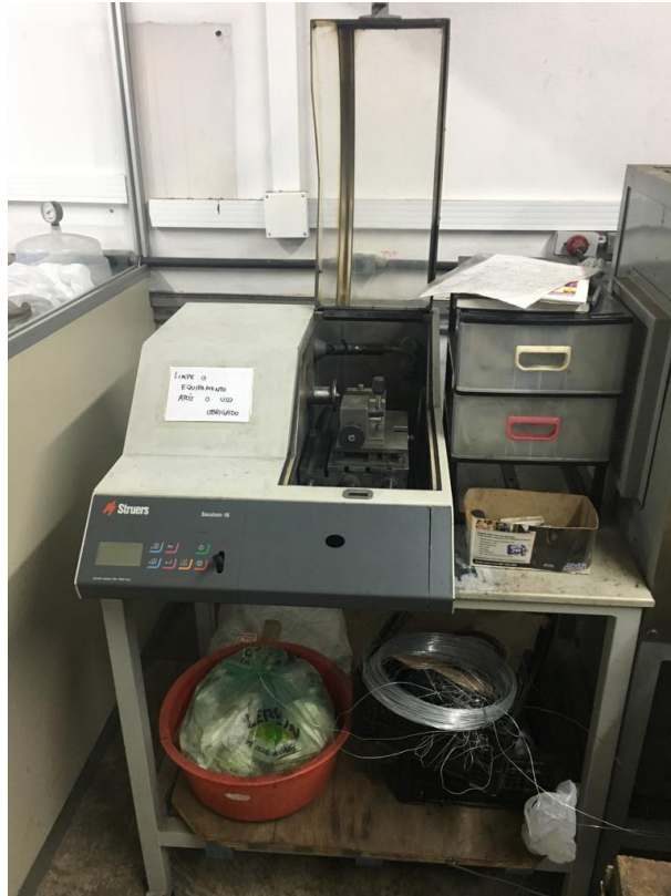
Figura 17: Máquina de corte utilizada para preparação das amostras
