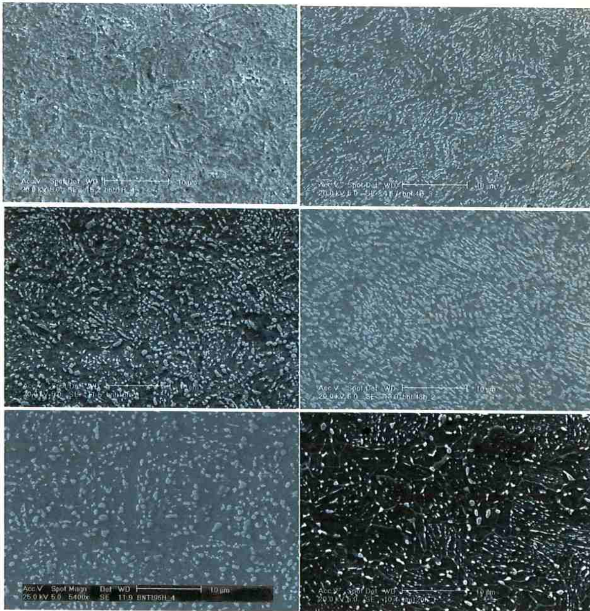
Figura VI Amostras de bainita inferior esferoidizadas a 680°C, atacadas com Nital 1% e observadas ao microscópio eletrônico com um aumento de 5400X: 1, 4, 16, 48, 96 e 120 horas de esferoidização.
