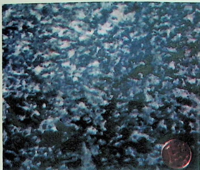
← Figura 4 - Nesta parte da rocha observa-se uma concentração de biotita muito maior do que as concentrações vistas anteriormente. Representam uma polêmica quando comercializadas, pois a heterogeneidade da rocha pode sugerir sua depreciação (irregularidade de produção e tecnológica) ou valorização (estética e artística).
