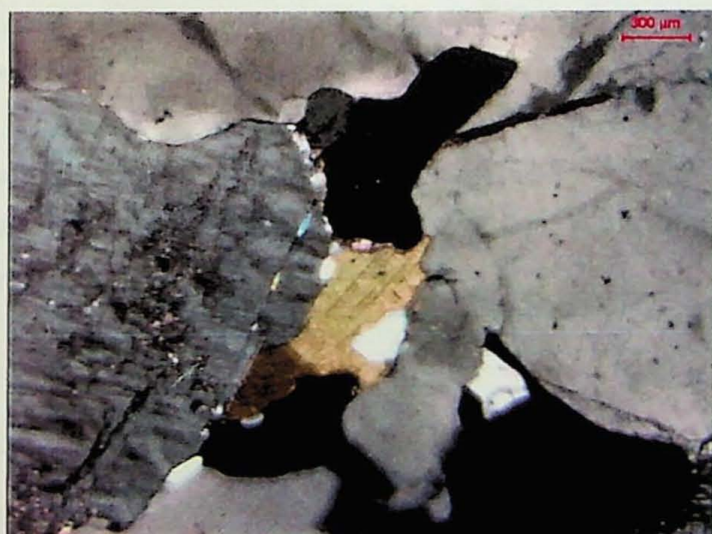
Figura 27 - Esquerda. Em uma microfotografia de rocha, seção delgada, aumento de 2,5x e com nicóis cruzados.. Este biotita monzogranito é uma rocha equigranular, com granulação média a grossa e com a seguinte mineralogia: quartzo, feldspato, anfibólio e muscovita. Pela grande extensão do corpo granítico de Três Córregos há uma variação de algumas características da rocha, em que alguns casos podem causar grandes diferenças no seu comportamento quando utilizadas na construção.
