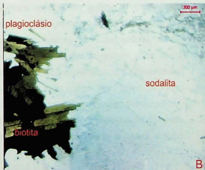
Figura 6 - As fotos, acima, apresentam uma parte da mineralogia representante da sodalita sienito, observa-se que entre os grãos de plagioclásio, sodalita e biotita e grande quantidade de minerais menores de plagioclásio e carbonatos preenchendo os espaços entre os grãos maiores. Aumento de 2,5x no microscópio petrográfico. Com nicol cruzado (A) e descruzado (B).
