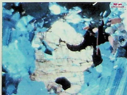
Figura 31 - Nesta imagem a direita, pode-se observar um grão de ortopiroxênio (hiperstênio), mineral característico do chamoquitos. A foto foi tirada de uma seção delgada de rocha, com aumento de 2,5x e nicóis cruzados.
