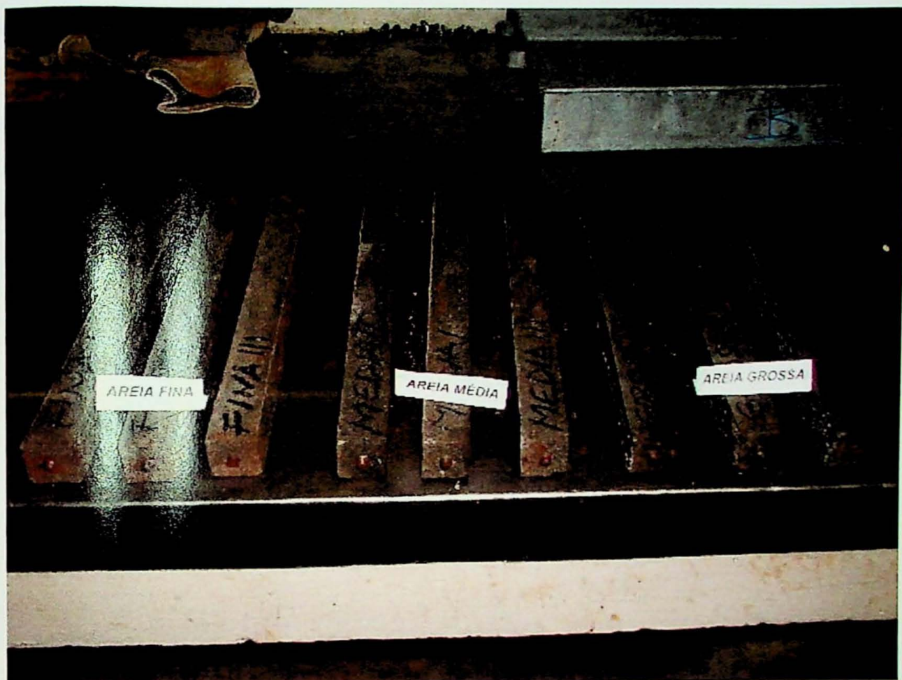
Foto 22 – Barras de expansibilidade feitas com areia coletada em campo destacando as 3 frações.
