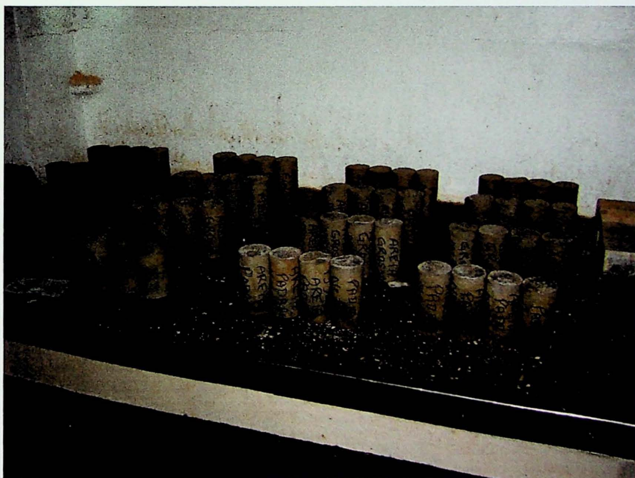
Foto 18 – Desmoldagem dos corpos de prova
