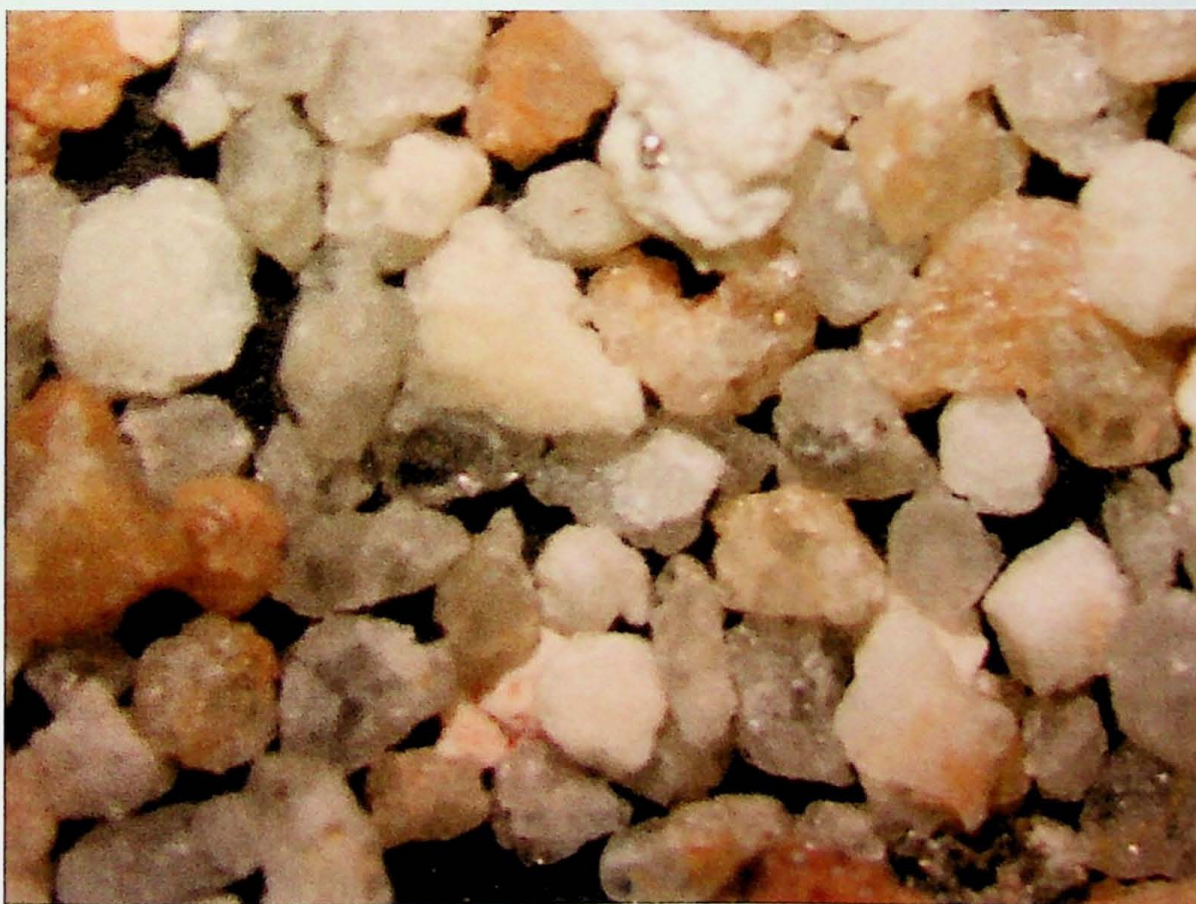
Foto 14 – Faixa granulométrica entre as malhas mesh # 48 (0,3 mm) nota-se grãos com superfície mais polida
