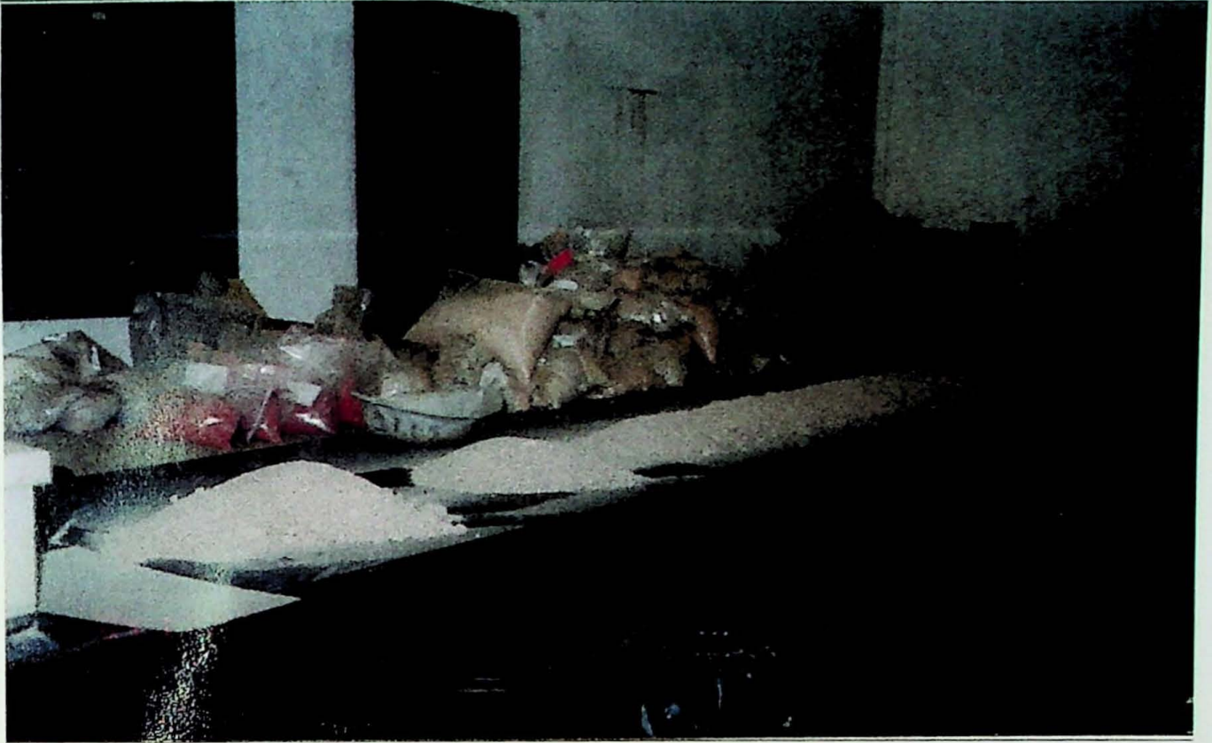
Foto 07 – Pilha de homogeneização (amostra areia de desmonte hidráulico/ Parelheiros)
