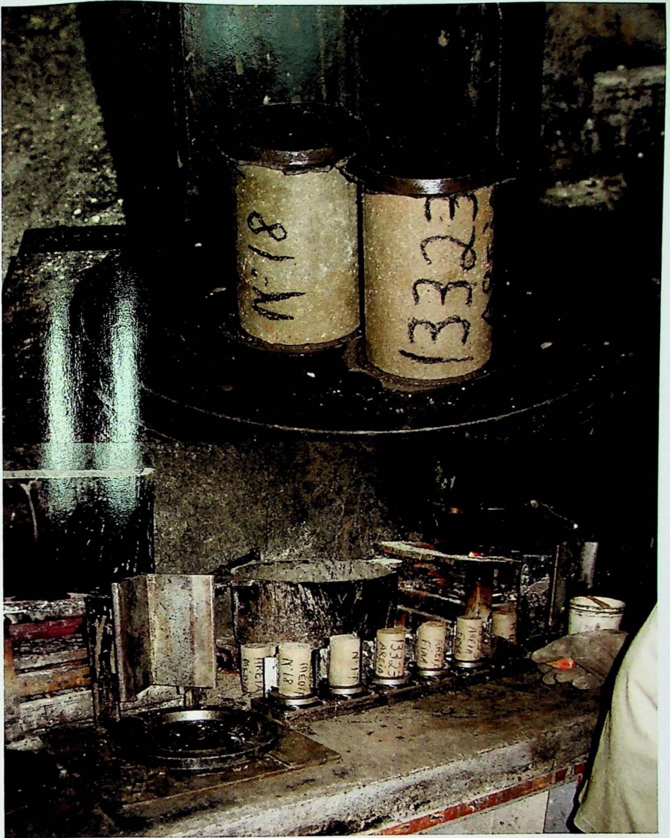
Fotos 19 e 20 – Capeamento superficial dos corpos de prova com solução de enxofre mais pozolana.
