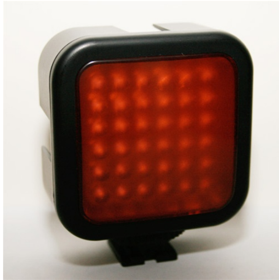
Figura 5.1: Exemplo de iluminação difusa com leds .
