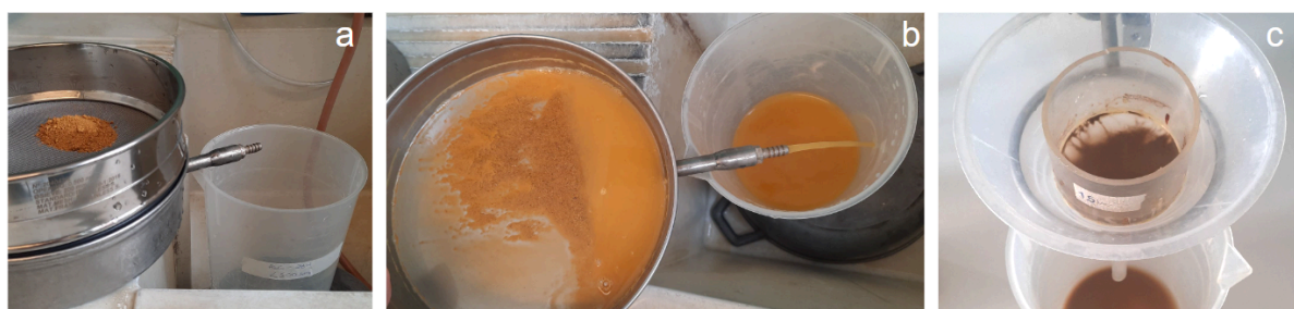
Figura 5. (a) Início do processo de peneiramento por via úmida. (b) Recuperação do material menor que 500 \mu\text{m} em um béquer. (c) Peneiramento do material em uma peneira de 15 \mu\text{m} .
