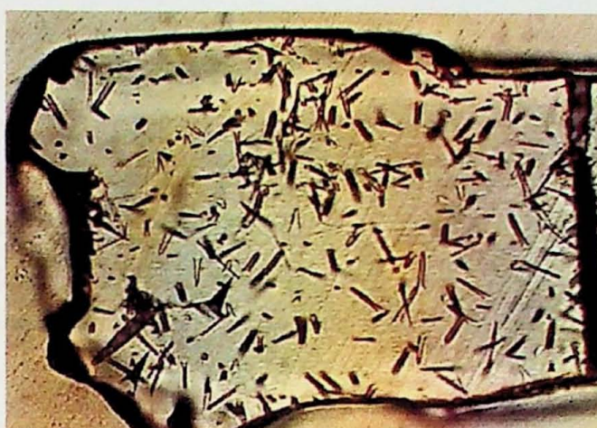
Figura 15 – Fotomicrografia de uma seção prismática de um cristal de apatita polido e atacado. O eixo mais longo do cristal possui aproximadamente: 150 \mu m
