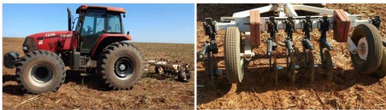
Figura 4. Sensor de condutividade elétrica de contato modelo V3100 (Veris Technologies, Salina, Kansas) acoplado a um trator CASE MX 150 pertencente à usina.
