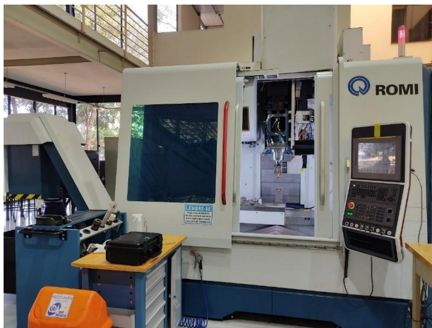
Figura 7: Máquina de manufatura híbrida (LP-DED e usinagem) produzida pela Indústrias Romi S.A., modelo D800 Hybrid.
