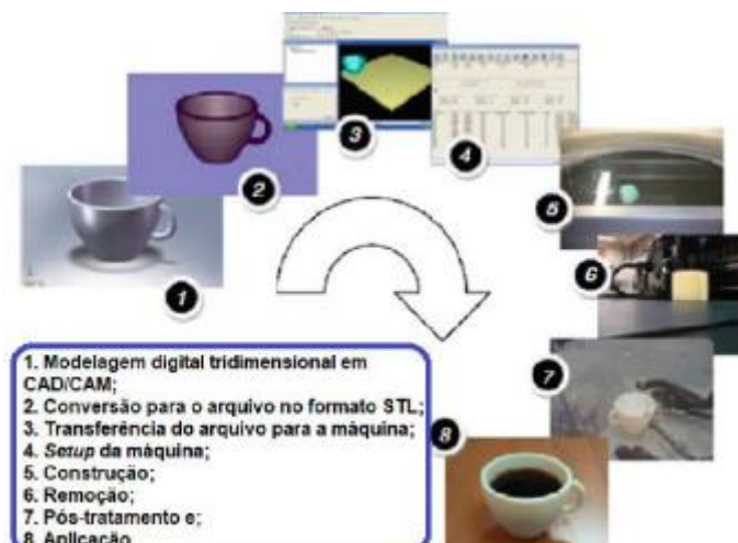
Figura 1: Etapas de fabricação da Manufatura Aditiva.
