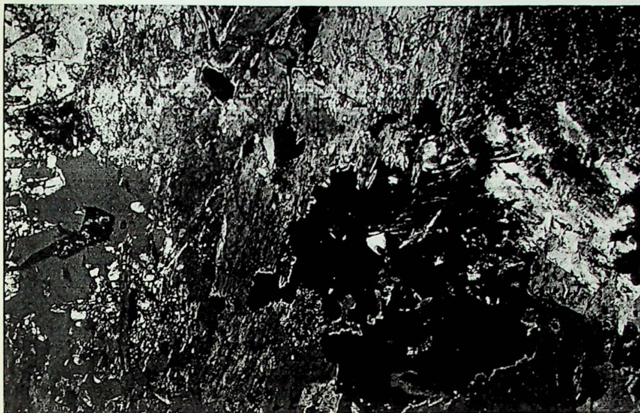
Fotomicrografia 7 (Lâm. SM23b): Zona de transição Rocha sã X r. hidrotermalizada. Ocorre epídoto (sup., esq. e dir.), diopsídio (centro) envolvido por Tchermakita e ainda inclusões de allanita metamórfica no anfibólio. Obj. 2.5x Pol. X
