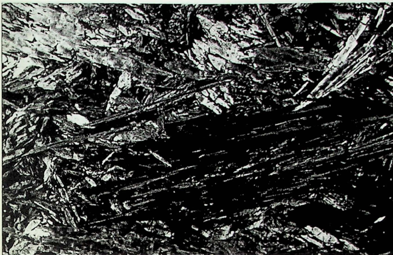
Fotomicrografia 3 ( Lâm. P11B): Acículas de ortoanfíbólio apresentando geminação polissintética (centro), e de actinolita (sup. esq), em meio a clorita magnesiana fina.
