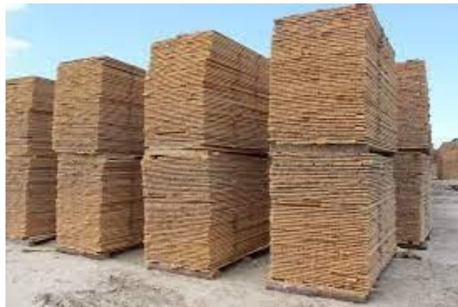
Figura 7- Secagem de madeira ao ar livre
