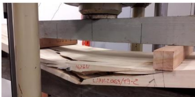
Figura 30- Detalhe de ruptura no corpo de prova
