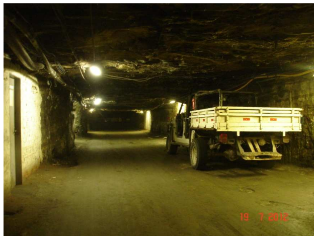
Fig. 5: Mina subterrânea de Taquari-Vassouras: Transporte até as frentes de lavra por carros à partir do elevador. As frentes de lavra alcançam profundidades superiores a 700m.
