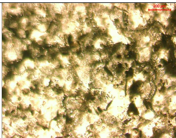
II-HF1(2): Textura geral do exemplar de halita fina. Lâminas de halita microcristalina com matéria orgânica finamente intercaladas.
