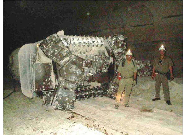
Fig. 8: Minerador Marietta: Rotores de 1,80m de diâmetro. (Fontes, 2003)
