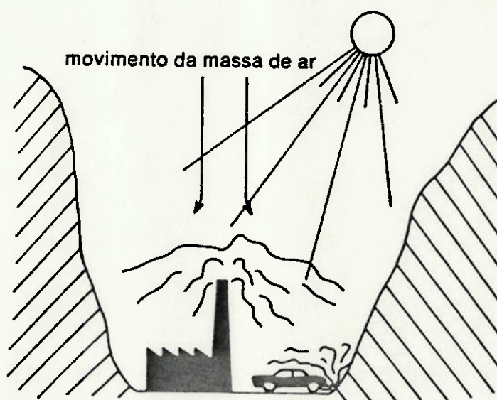
FIGURA 2.5 - Acúmulo de poluentes devido a pressões atmosféricas elevadas
