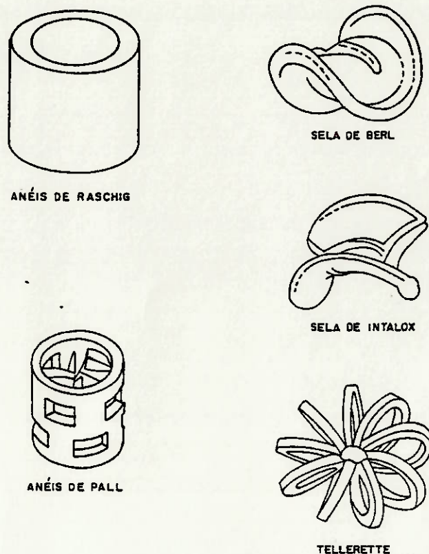
FIGURA 6.20 - Tipos de enchimento para torres de absorção
