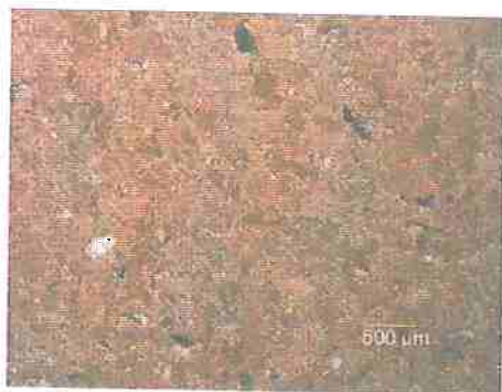
Figura 12 - Microestrutura cerâmica, taguá #50, 0% de vidro.
