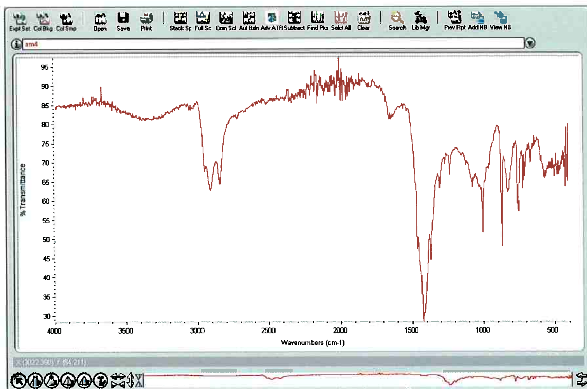
Figura 44 : Análise de infravermelho da amostra composta por luvas(80%) + borracha natural (20%).
