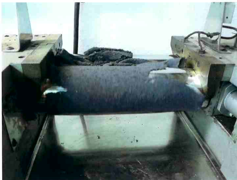
Figura 26 : Imagem da massa após incorporação total de 10PCR de PP + 10PCR de AM, antes da introdução dos aditivos.
