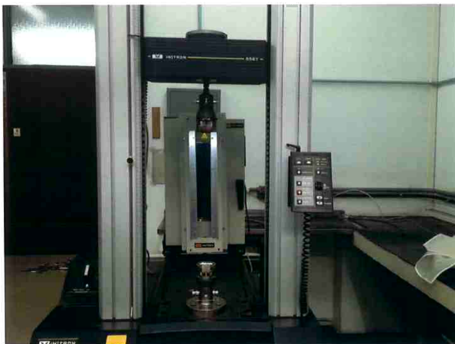
Figura 31 : Imagem da máquina Instron modelo 5567 utilizada nos testes de tração.
