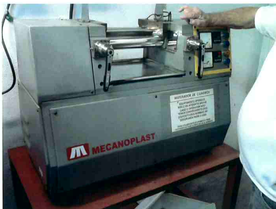
Figura 20 : Imagem da calandra utilizada no processamento das massas.
