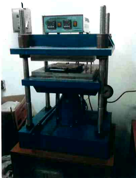
Figura 22 : Imagem da prensa utilizada para vulcanizar as massas.
