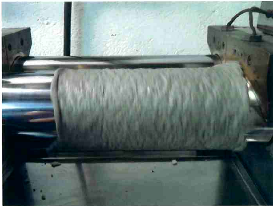
Figura 21 : imagem da borracha natura sendo processada na calandra.
