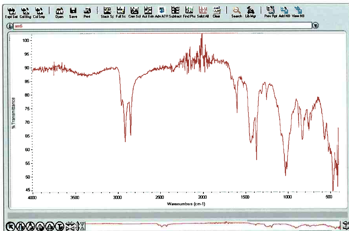
Figura 45 : Análise de infravermelho da amostra composta por luvas(80%) + borracha natural (20%) + 10 PCR CCA + 10 PCR PP.
