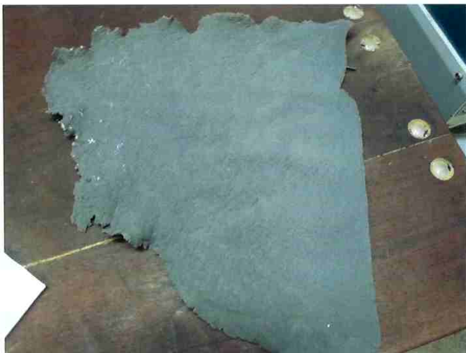
Figura 27 : Metade de uma das massas 120g após a incorporação de 10PCR de CCA + 10PCR de AM e introdução de aditivos após passagem pela calandra; e antes da passagem na prensa.
