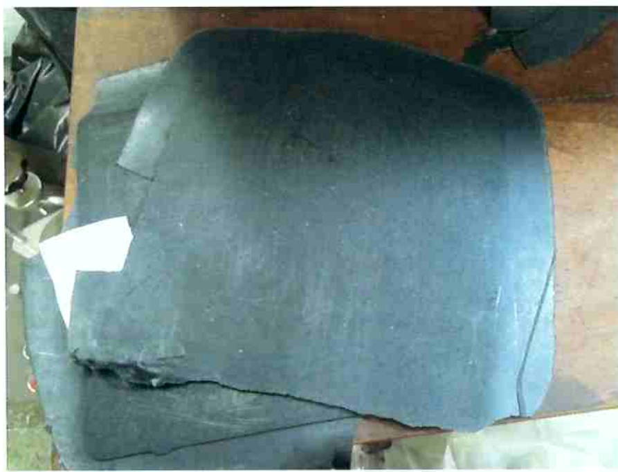
Figura 28 : Metade de uma das massas de 120g após a incorporação de 10PCR de CCA + 10PCR de AM e introdução de aditivos, e após também passagem pela prensa.
