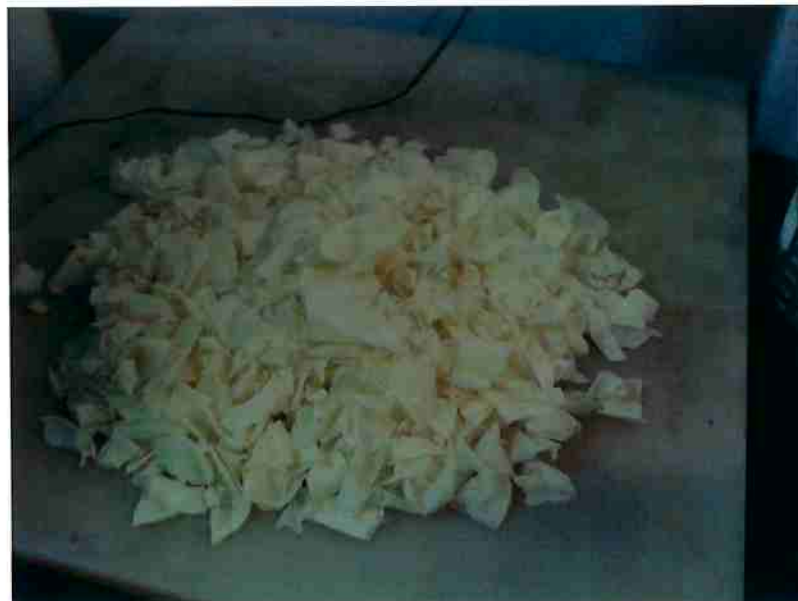
Figura 24 : Imagem das luvas recortadas antes de serem processadas na calandra.
