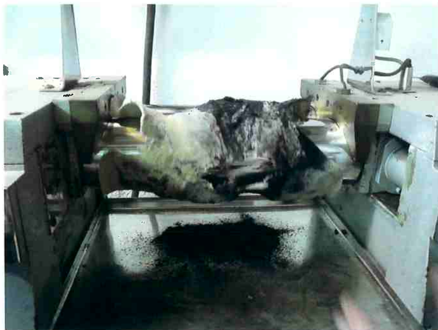
Figura 25 : Adição de carga enquanto a massa era processada na calandra. A carga não incorporada que pode ser observada na imagem era recolhida e adicionada outra vez à massa, que estava sendo processada na calandra. O processo foi repetido até que toda a carga fosse incorporada.
