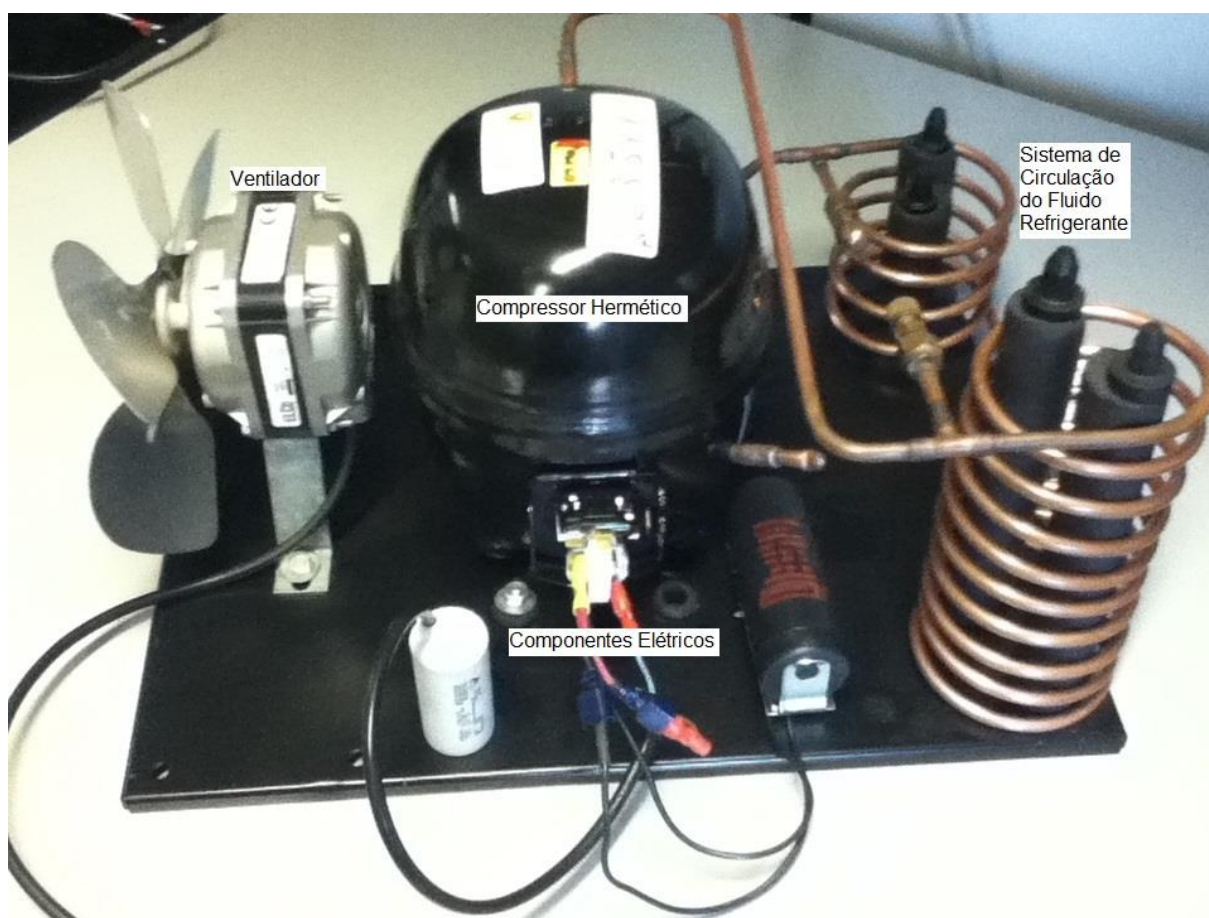
Figura 3.2 - Compressor e os seus componentes. (Fonte: próprio autor).
