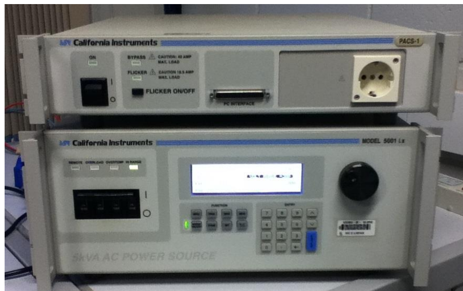
Figura 5.1 - O gerador arbitrário de sinais: modelo 5001iX da California Instruments . (Fonte: foto do próprio autor).
