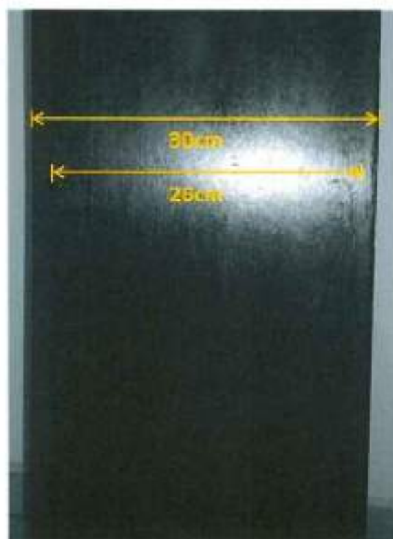
Figura 18 - Dimensões da parte lateral da caixa acústica
