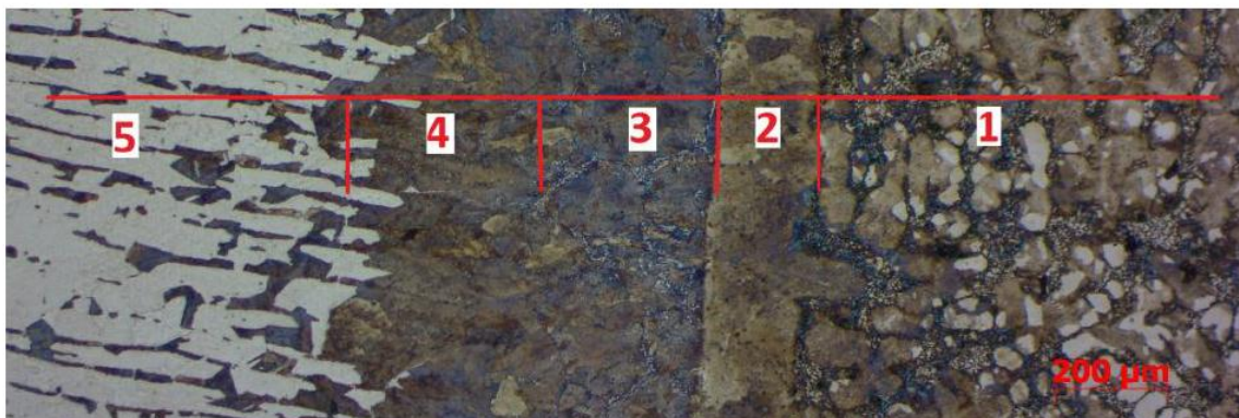
Figura 10 – Localização das microestruturas da junção (Nital 5%) (Nucci,Péricles-2002).
