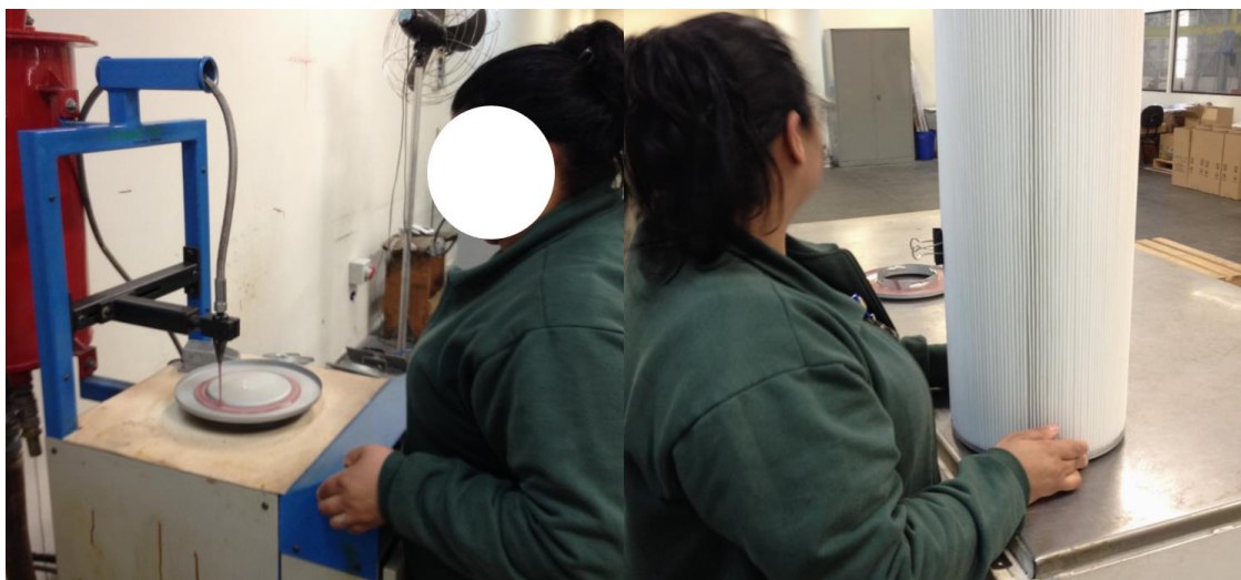
Figura 23: a esquerda, dosagem da resina na tampa, a direita, alocação da tampa inferior
