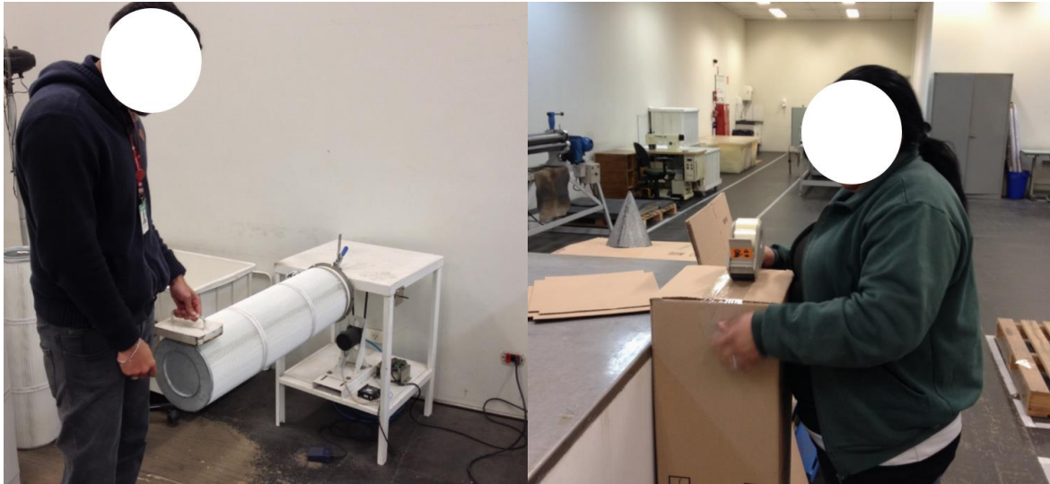
Figura 25: a esquerda, teste de resistência mecânica, a direita, embalo do filtro
