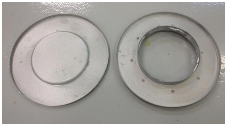
Figura 14: Tampas do filtro cartucho de aço-carbono após o jateamento
