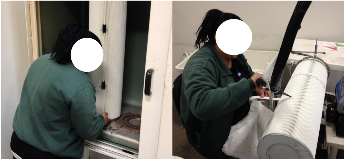
Figura 24: a esquerda, filtro sendo alocado no forno, a direita, colagem da cinta
