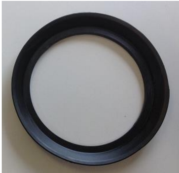
Figura 15: Selo usado para a fixação do filtro nos equipamentos
