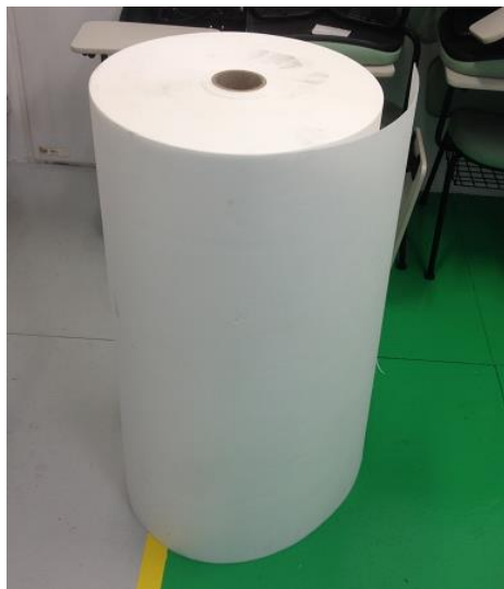
Figura 12: Elemento filtrante de poliéster do filtro cartucho
