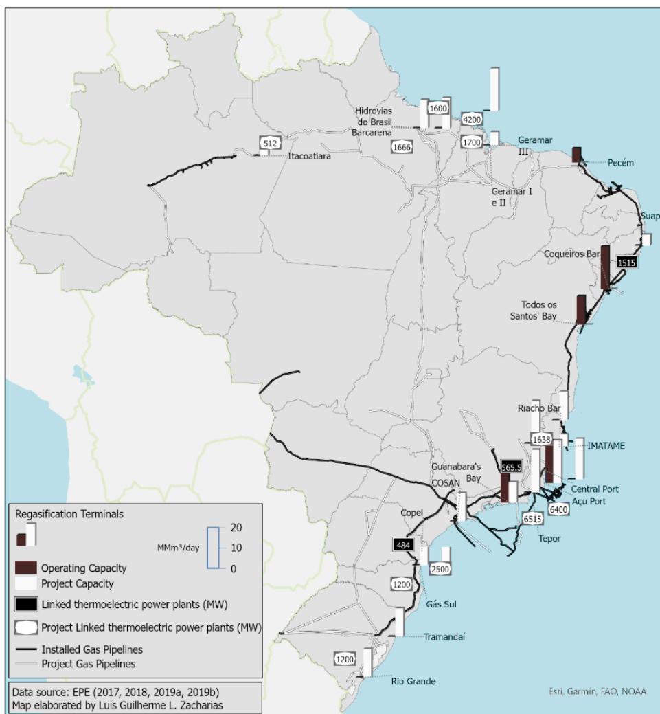
Figura 15 - Terminais de Regaseificação em operação e em projeto no Brasil, com alguns dos projetos âncoras em destaque.
