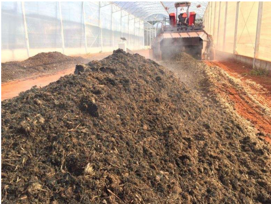
Figura 8 – Método de leira revolvida
