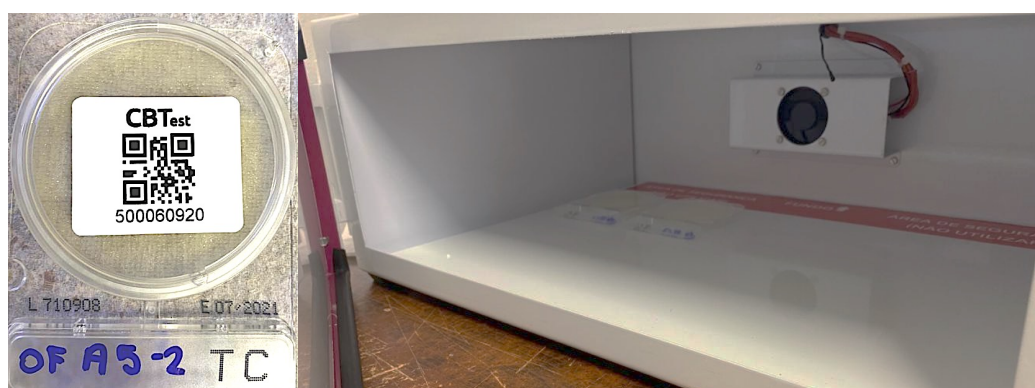
Figura 8: Placa identificada com o QR code (à esquerda) e placas no interior da estufa microbiológica na parte inferior do SmartLab (à direita).
