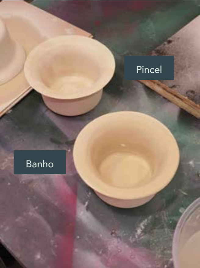
FIGURA 100 Cumbuca com esmalte aplicado por pincel e banho.
