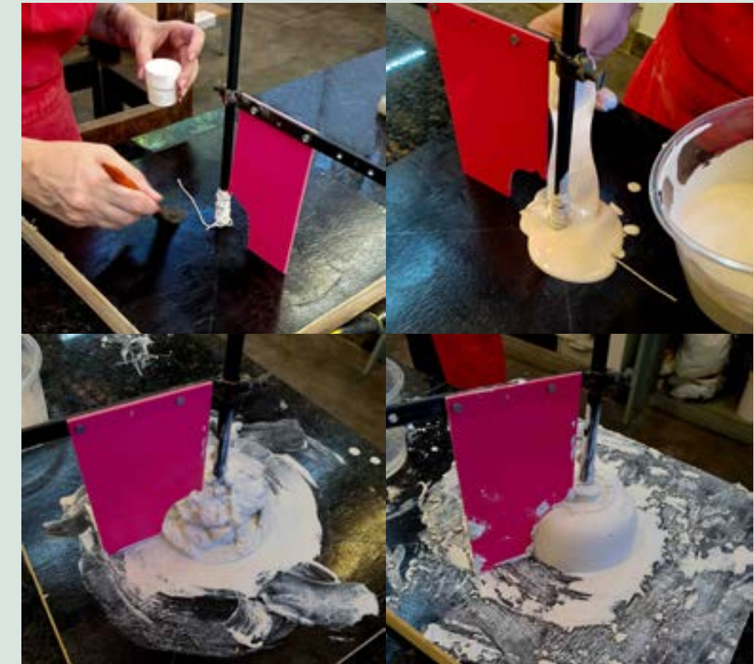
FIGURA 72 Professora Cristiane pincelando o desmoldante na base do torno (acima, à esquerda) e depejando a 1ª camada de gesso (acima, à direita). Peça se formando (abaixo, à esquerda) e a mesma quase finalizada (abaixo, à direita).
