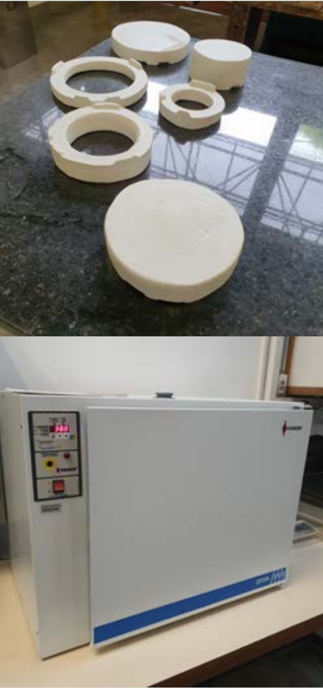
FIGURA 80 Moldes de gesso recém lavados (acima) e estufa já funcionando à 38.8°C (abaixo).
