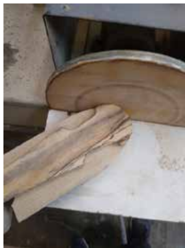
Foto 58: Lixamento do excesso na máquina. Fonte: Acervo pessoal.
