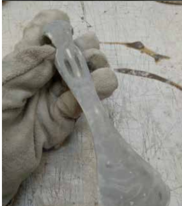
Foto 40,41, 42 e 43: Lixamento da peça. e aplicação de tinta primer na peça. Fonte: Acervo pessoal.
