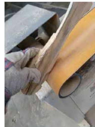
Foto 60: Lixamento da peça na máquina. Fonte: Acervo pessoal.
