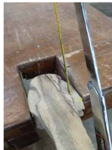
Foto 59: Corte do excesso com serra. Fonte: Acervo pessoal.
