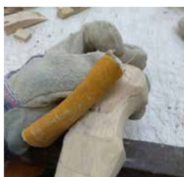
Foto 62: Ajustes manuais com a lixa. Fonte: Acervo pessoal.
