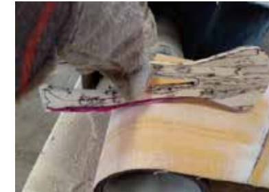
Foto 50: Lixamento do excesso. Fonte: Acervo pessoal.
