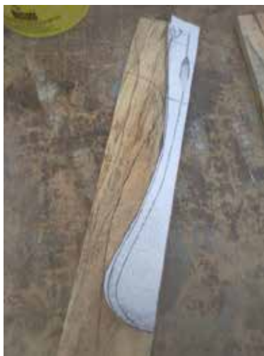
Foto 53: Marcação dos moldes na ripa. Fonte: Acervo pessoal.
