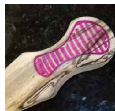
Foto 63: Marcação da parte côncava. Fonte: Acervo pessoal.
