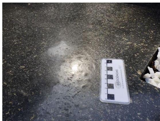
Figura 23: Bolhas em túmulo de Granito Preto Piracaia.
