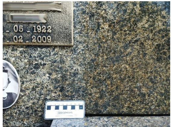
Figura 35: Eflorescência de sais em túmulo de Granito Verde Ubatuba.
