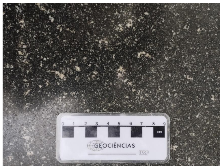
Figura 5: Granito Preto Bragança em túmulo do Cemitério São João Batista, Guarulhos.
