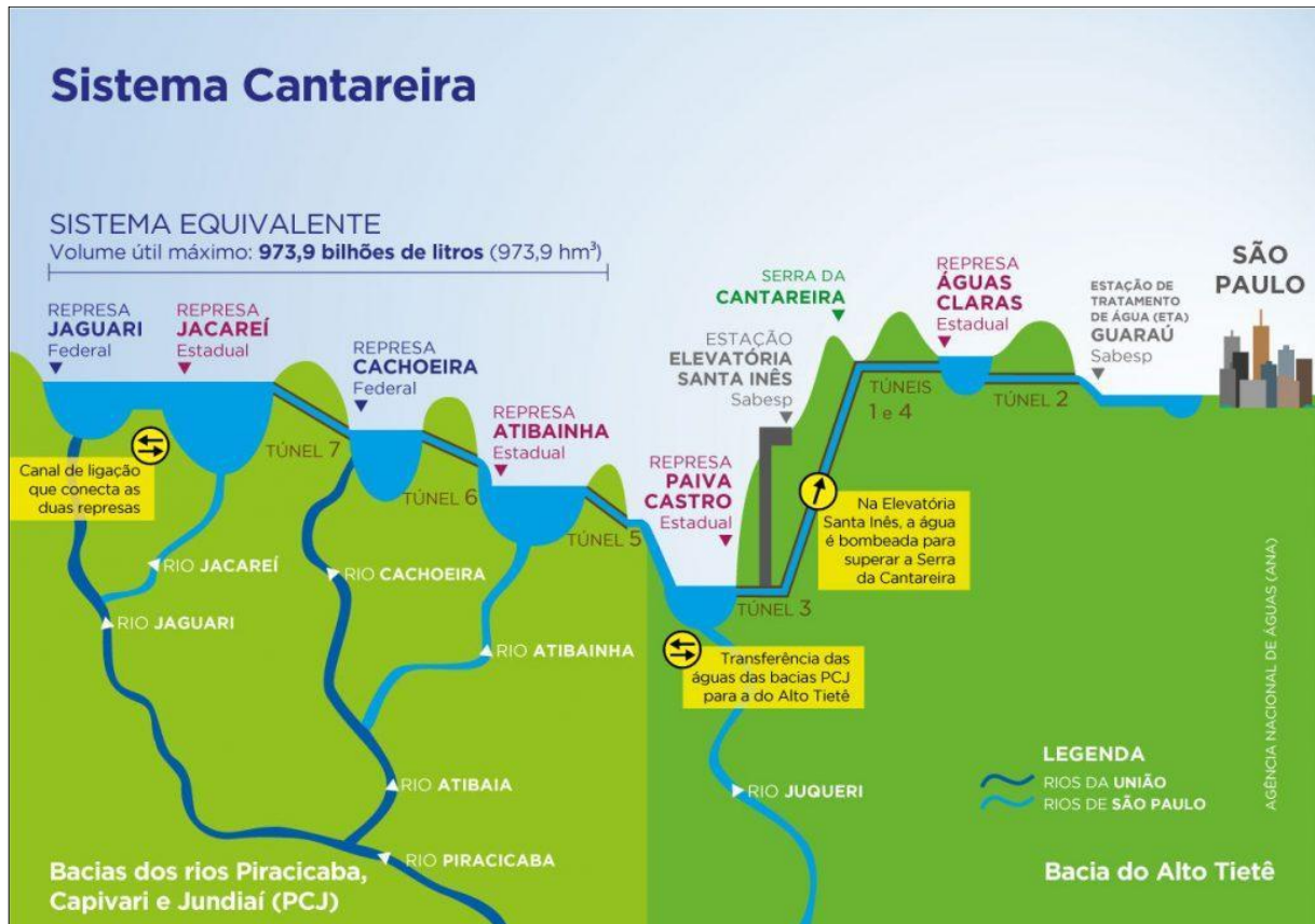
Figura 02 - Ilustração esquemática do Sistema Cantareira. Fonte: < www.gov.br/ana/pt-br > Acesso em novembro de 2021
