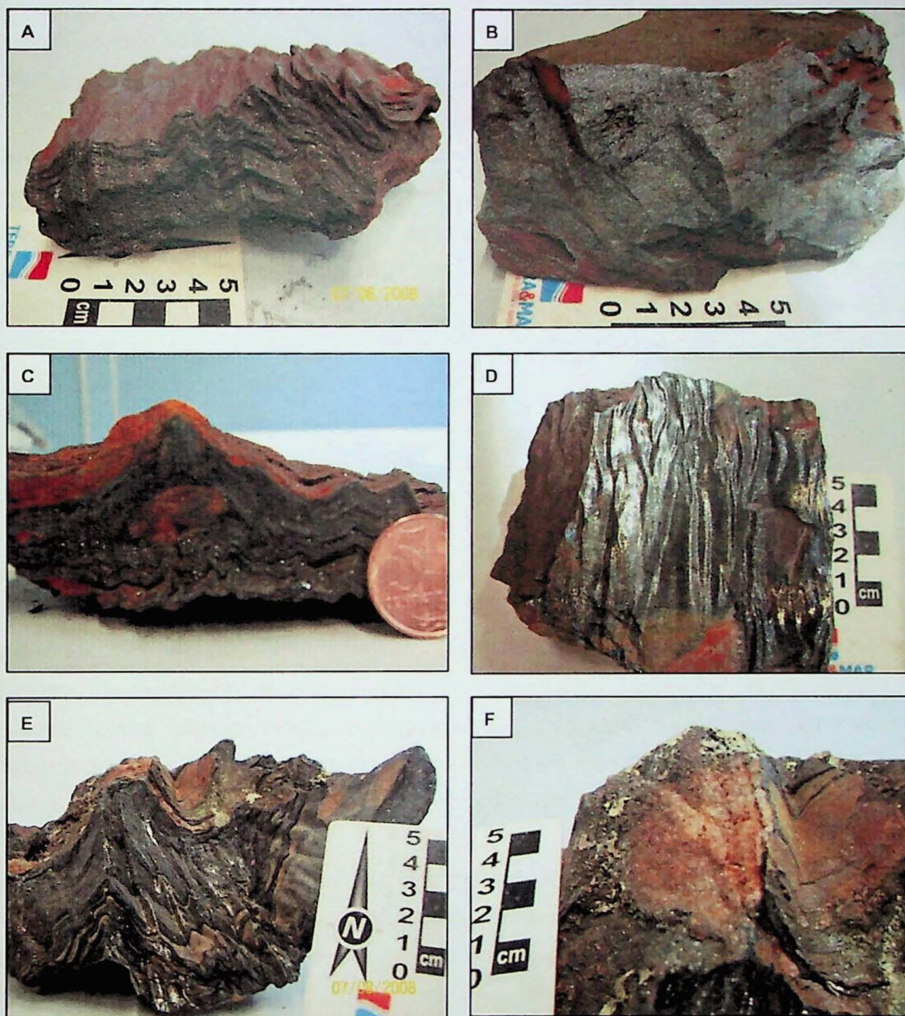
Figura 25 – Amostras A) PRT78 com estrutura crenulada; B) PRT81 com estrutura maciça; C e D) PRT56 estrutura crenulada com molde de clasto; E e F) PRT60 estrutura crenulada-dobrada com clasto de quartzito.
