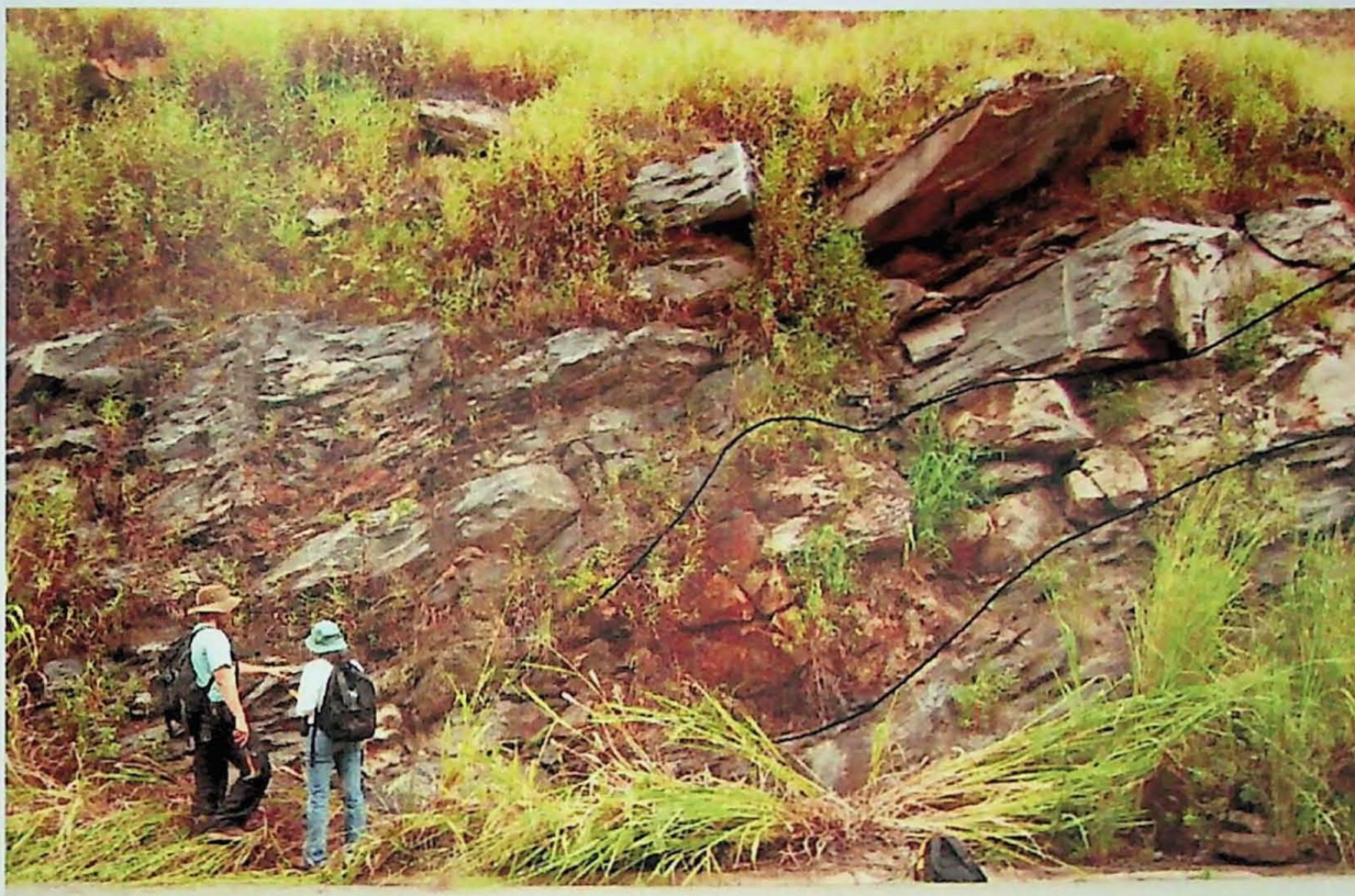
Figura 27 – Afloramento EP30 de metadiamicictito cinza intercalado com pacotes/lentes de quartzito de \pm 1,5 m de espessura.
