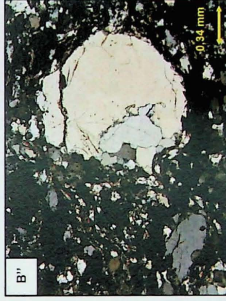
Figura 20 – Fotomicrografias com luz refletida, transmitida polarizador // e X – Destaca-se em A) PRT46: Hematita disseminada entre os grãos e clasto de quartzito fino ovalado; B) PRT79: Clasto de quartzito arredondado; C) PRT80: Grãos de quartzo subarredondados com hematita intersticial.
