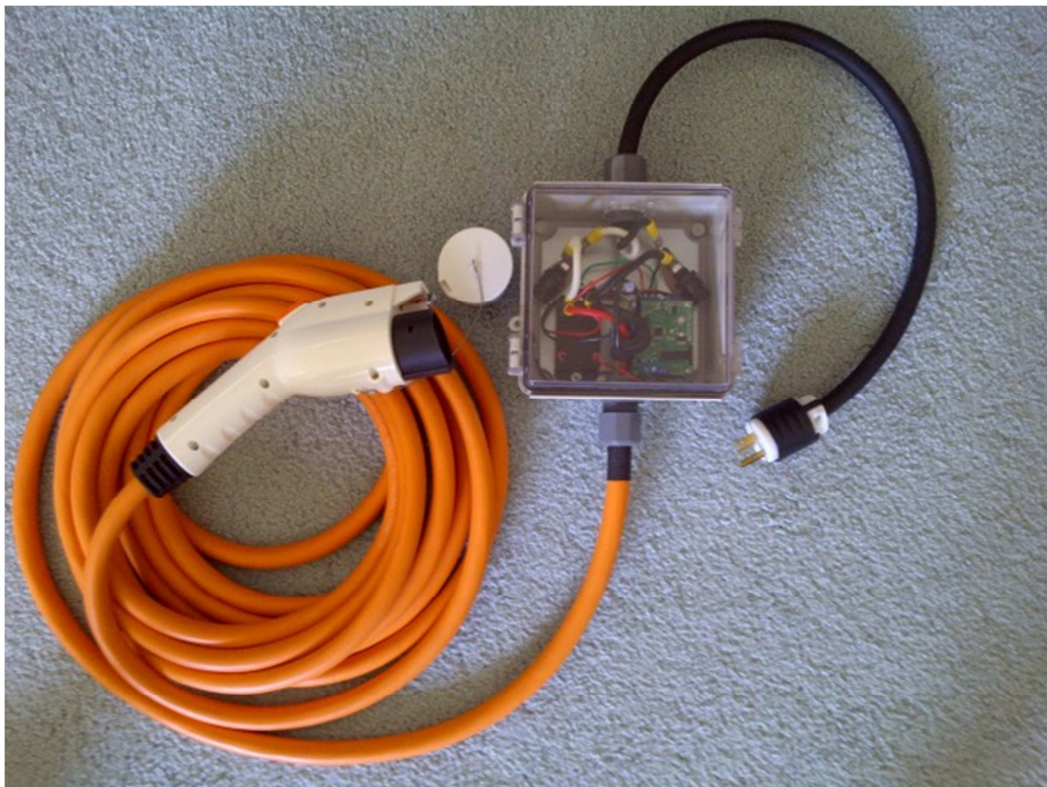
Figura 31 – Adaptador de tomada modo 3 para carregamento em uma tomada doméstica
