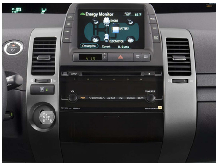
Figura 27 - Sistema de gerenciamento de energia de um veículo híbrido
