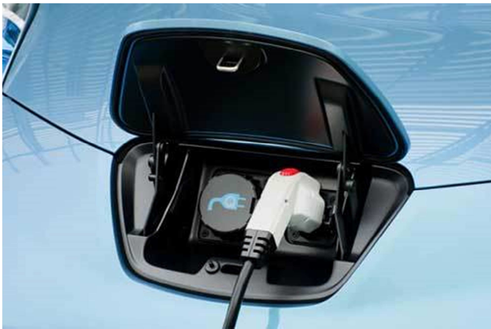
Figura 32 - Tipo de conexão modo 3 de carregamento
