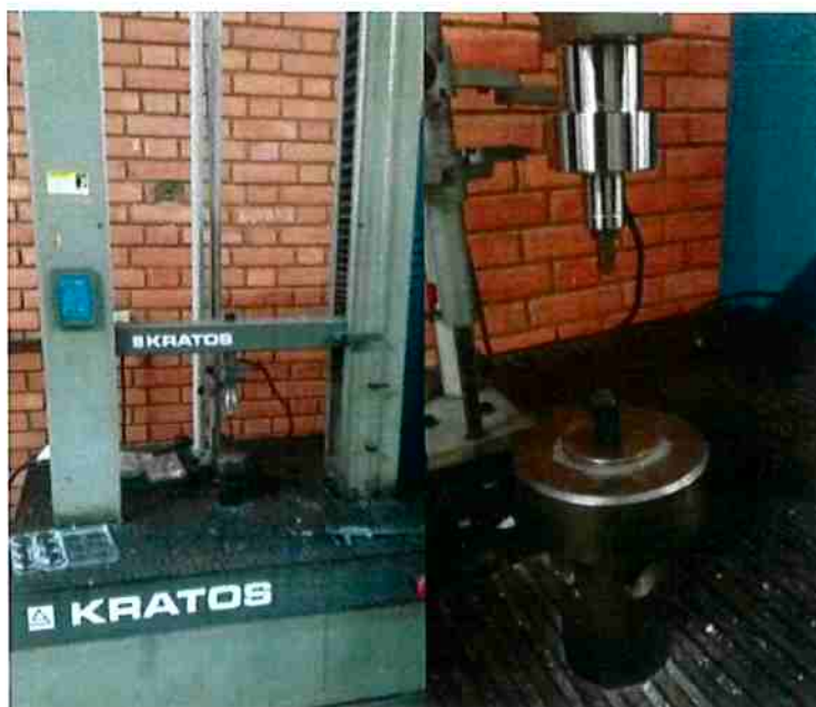
Figura 42 Sequência de imagens que mostra a máquina de ensaio universal adaptada para realizar o ensaio de dureza Janka
