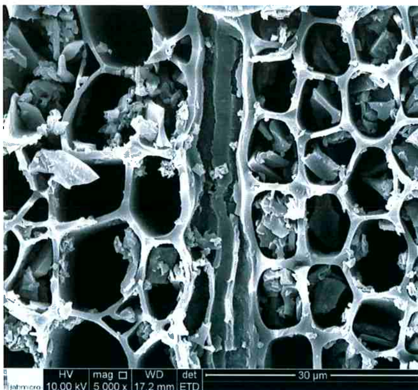
Figura 63 Detalhe da amostra de eucalipto carbonizada a 600°C. Aumento de 2000x
