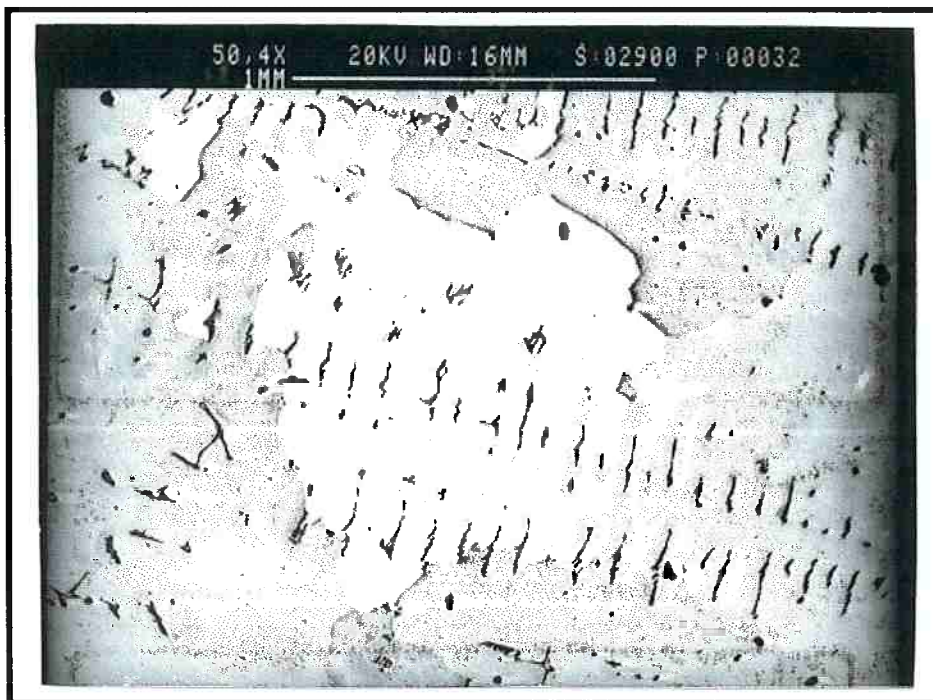
Figura 17 - Imagem de elétrons retroespalhados. Microestrutura típica da liga 2a, fase contínua clara é \gamma' e fase escura é \beta
