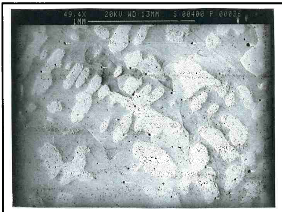
Figura 18 - Imagem de elétrons retroespalhados. Microestrutura típica das amostras 3 (com resfriamento controlado), 4 e 5.
