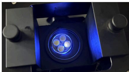
Figura 8 - Suporte para medidas de microscopia confocal em solução, durante medida.
