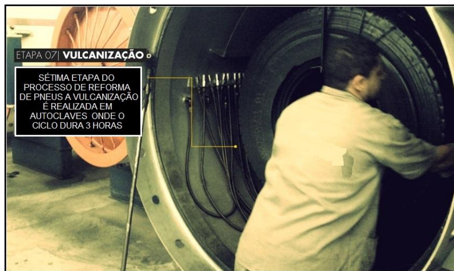
Figura 51 – Vulcanização Fonte: Arquivo da empresa
