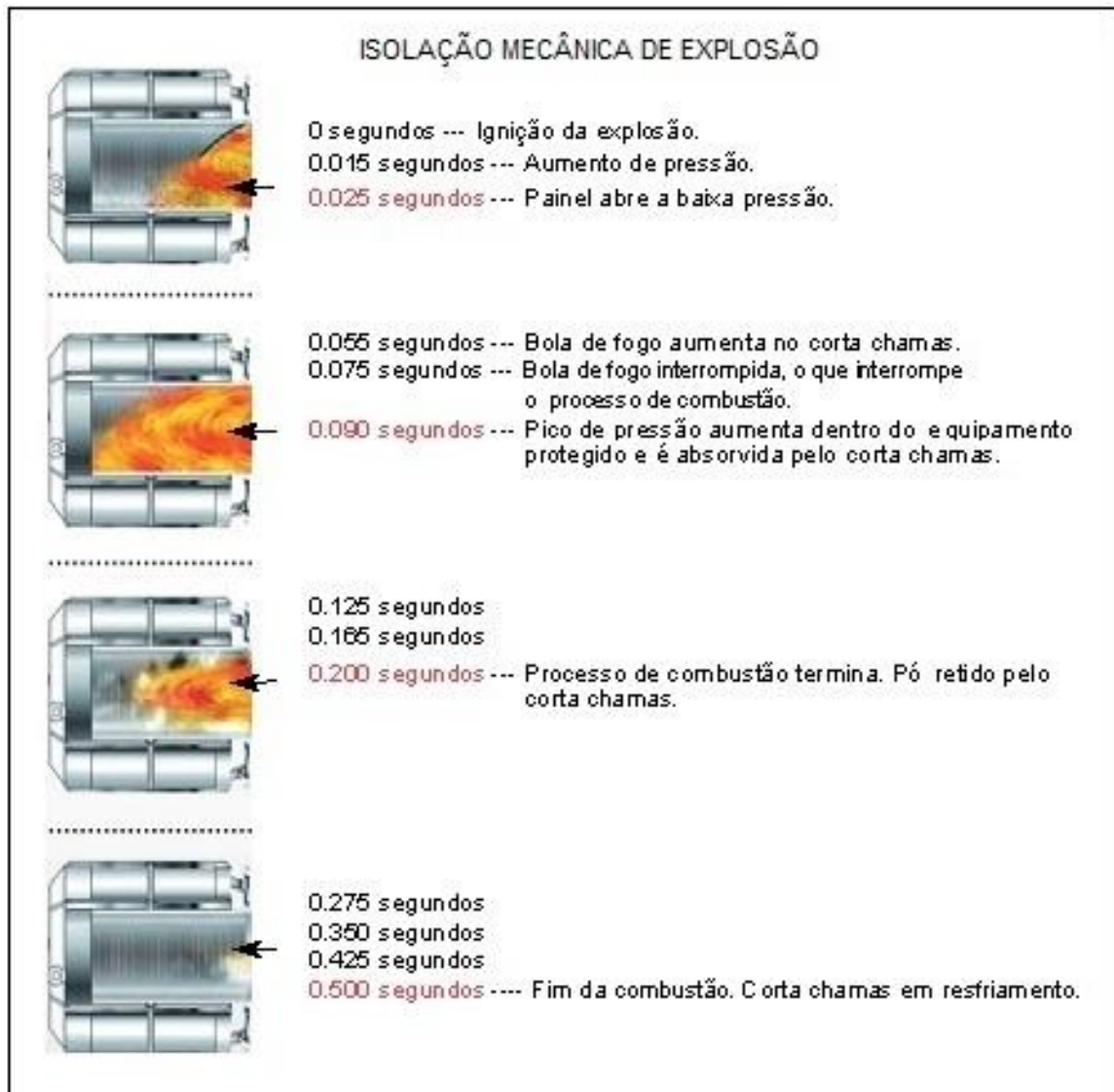
Figura 26 – Sequência de atuação do sistema de isolamento mecânico de explosão.
