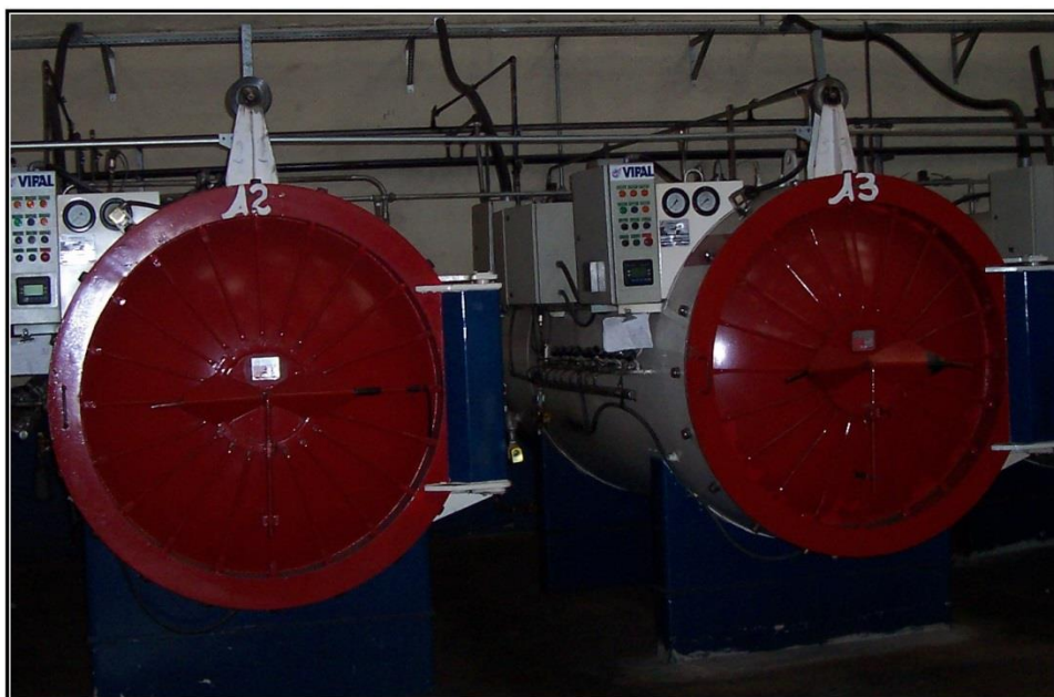
Figura 52 – Autoclaves - Vulcanização Fonte: Arquivo da empresa
