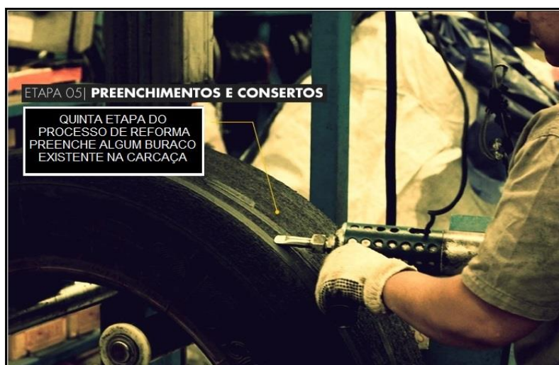
Figura 49 – Preenchimento e consertos Fonte: Arquivo da empresa
