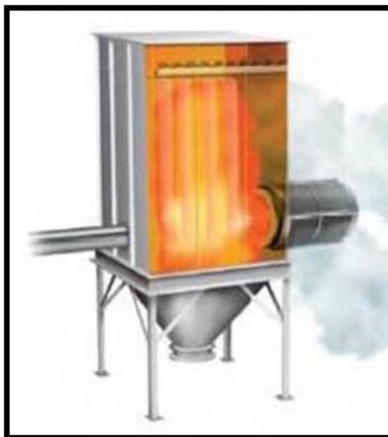
Figura 22 – Equipamento com abertura para instalação do painel de explosão. Fonte: (KRAUSE, 2009)
