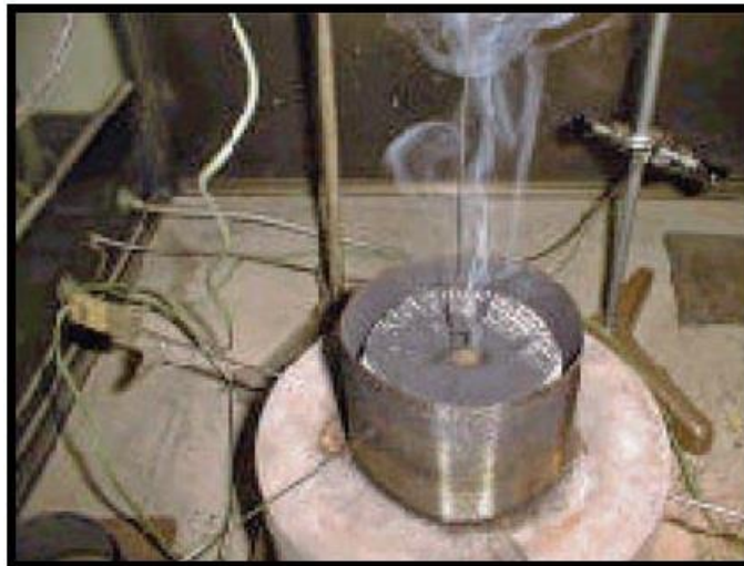
Figura 8 - Teste MIT para camadas espessas. Fonte: (BARTON, 2002)
