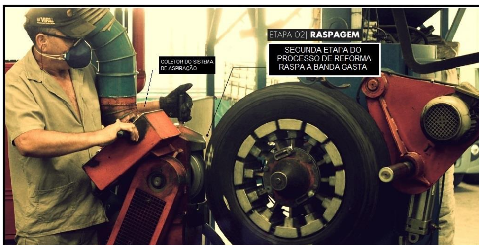
Figura 45 – Raspagem. Fonte: Arquivo da empresa
