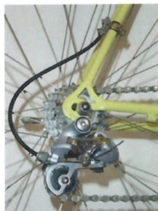
Fig. 23 - O câmbio e a fixação da saída do cabo
