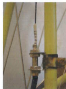
Fig. 27 - A marcação do \Delta L no cabo
