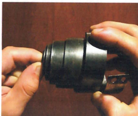
Fig. 19 - Deformação exacerbada ilustrativa da operação alternativa da mola espiral
