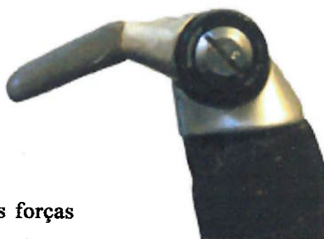
Fig.16 - A consagrada chave “gonzo” de operação do câmbio
