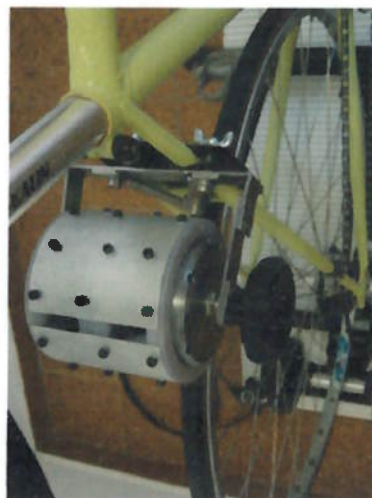
Fig. 33 - O mecanismo instalado na bicicleta protótipo
