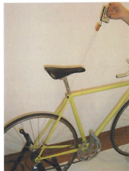
Fig. 26 - O aparato de ensaio para a obtenção da tração T
