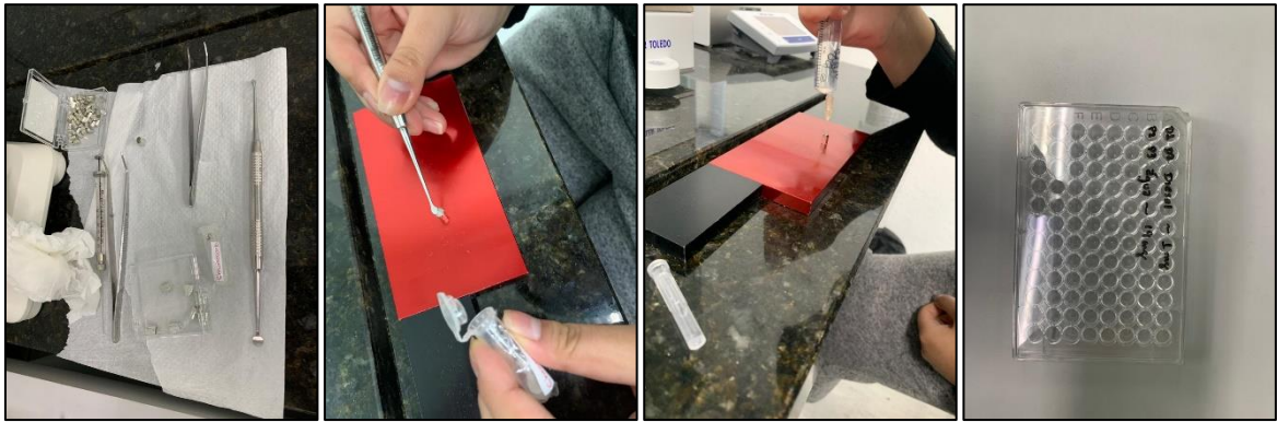
Figura 17: Materiais utilizados para preparação da cápsula de estanho, inserção do chromosorb, inserção do líquido a ser analisado e separação do material para análise, respectivamente.
