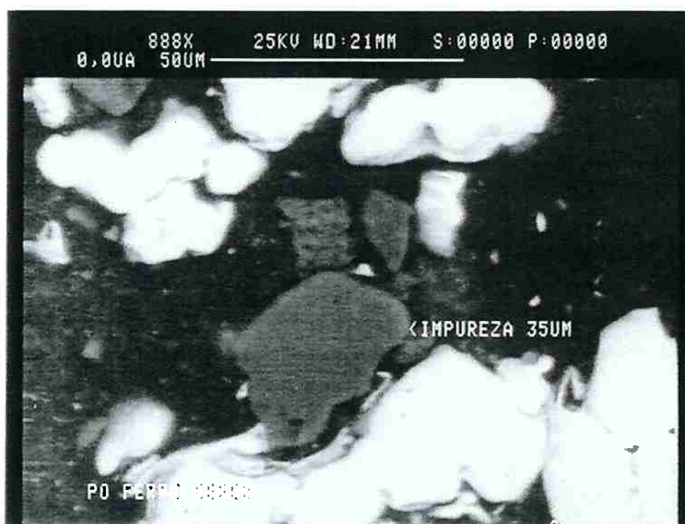
Figura A1/6 - Impureza presente no pó de ferro DS 205, possivelmente proveniente do polimento
