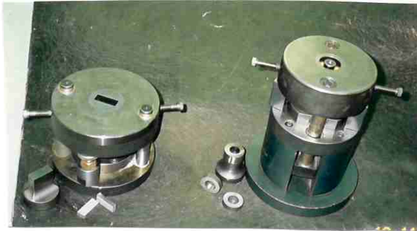
Figura 25 - Matrizes de compactação de barras e anéis
