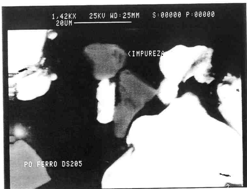
Figura A1/7 - Impureza presente no pó de ferro DS 205
