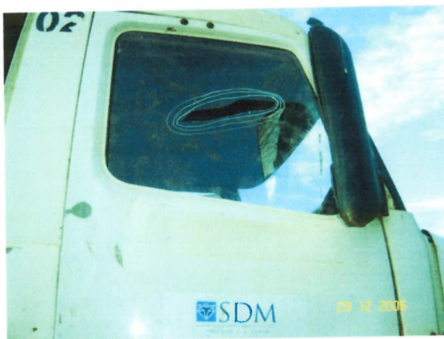
Figura 7: vidro do caminhão improvisado com acrílico e abertura para circulação de ar.
